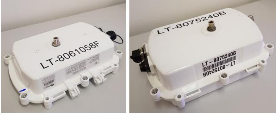
Fotografia 4 – Roteador e coletor de dados em campo
