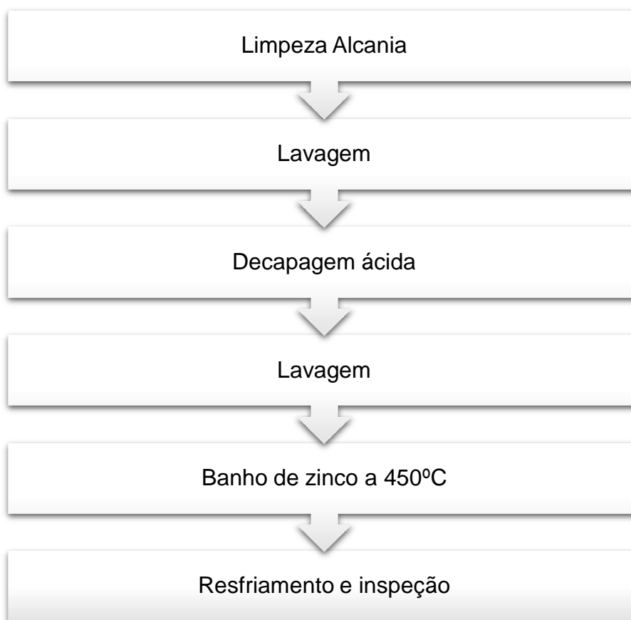
Figura 12 - Fluxograma do processo de galvanização a fogo
