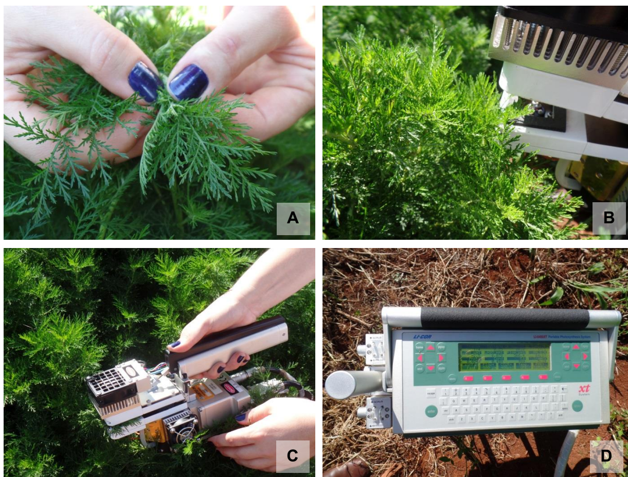
Figura 28 – Mensurações dos parâmetros fisiológicos com o aparelho IRGA 6400xT em quatro genótipos e uma variedade de A. annua cultivadas em campo na Unidade Experimental da UTFPR – Pato Branco. A) Sobreposição de folhas de A. annua para mensuração com o aparelho IRGA. Isso é necessário pela característica da folha ser composta. B,C) Momento da mensuração com IRGA: o período adequado para coletar uma medida confiável é a estabilização do CV(%) em no mínimo 0,5. D) Gravação dos dados no aparelho IRGA. Após os mesmos são descarregados em um computador para posterior análise.
