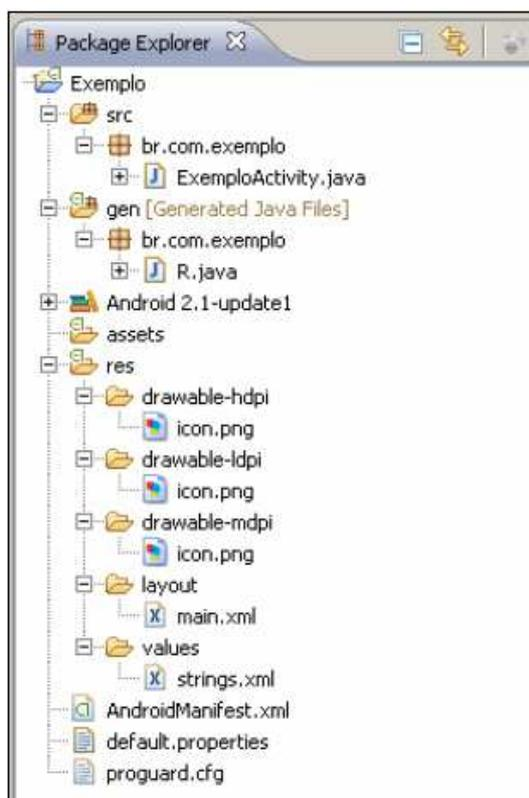
**Figura 3 – Estrutura de um projeto *Android* gerado pela IDE Eclipse SDK.**
