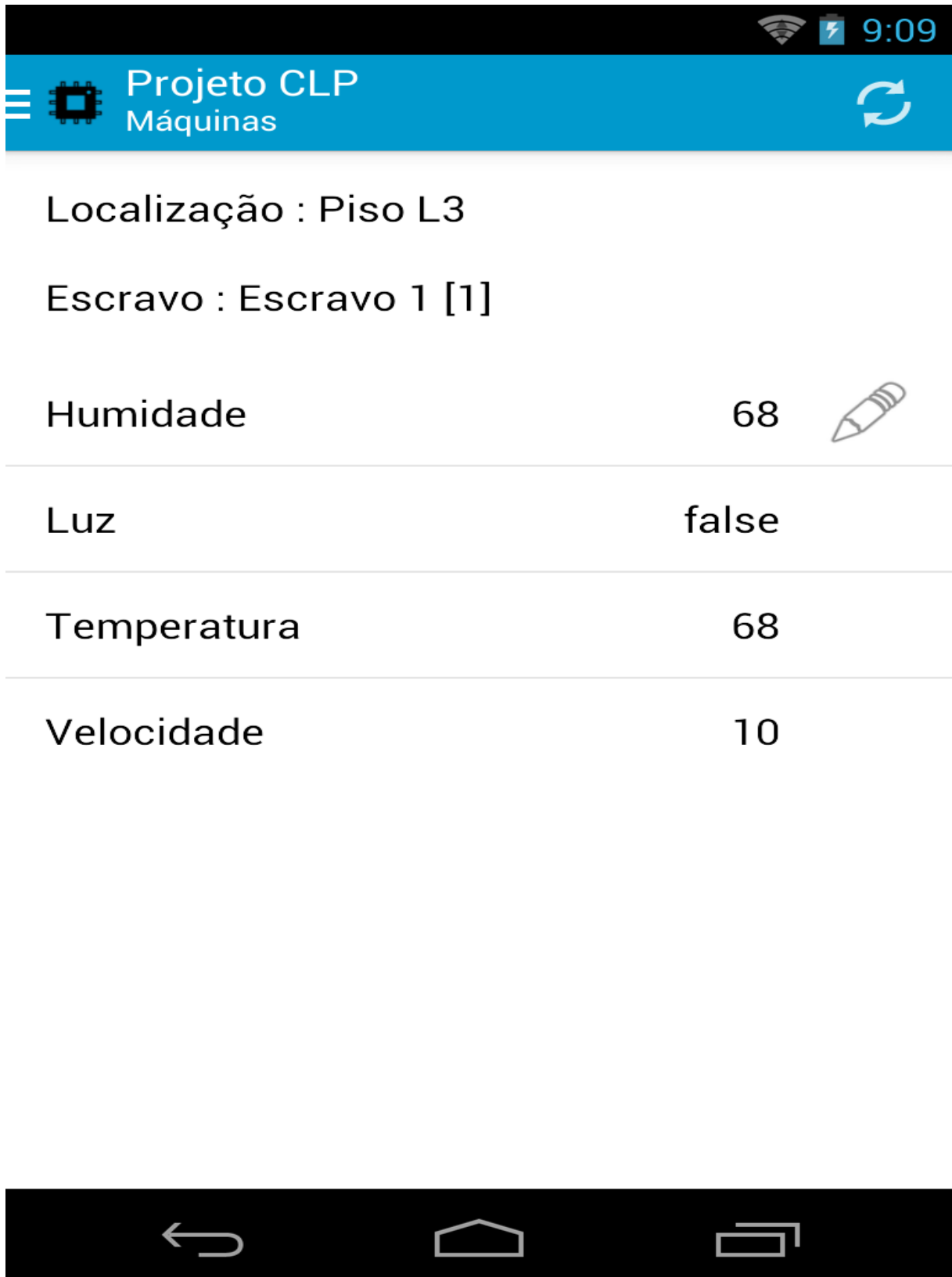
Figura 56: Módulo Móvel - Listagem de Registradores do Escravo
