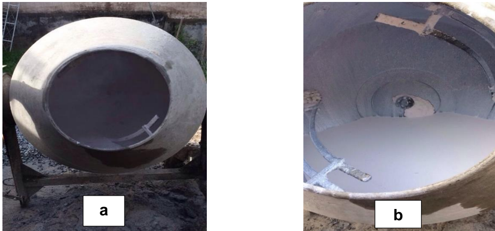
Figura 3 - Foto de betoneira contendo (a) cal reagindo com água (queima da cal), (b) Cal hidratada – hidróxido de cálcio (leite de cal).
