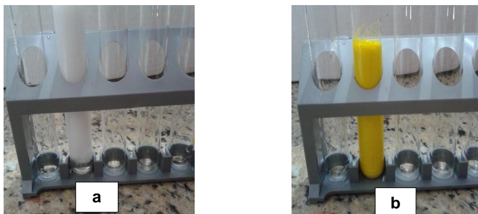
Figura 4 - Reações químicas com formação de um precipitado: ( a ) Tubo de ensaio contendo cloreto de prata; (b) Tubo de ensaio contendo iodeto de chumbo.
