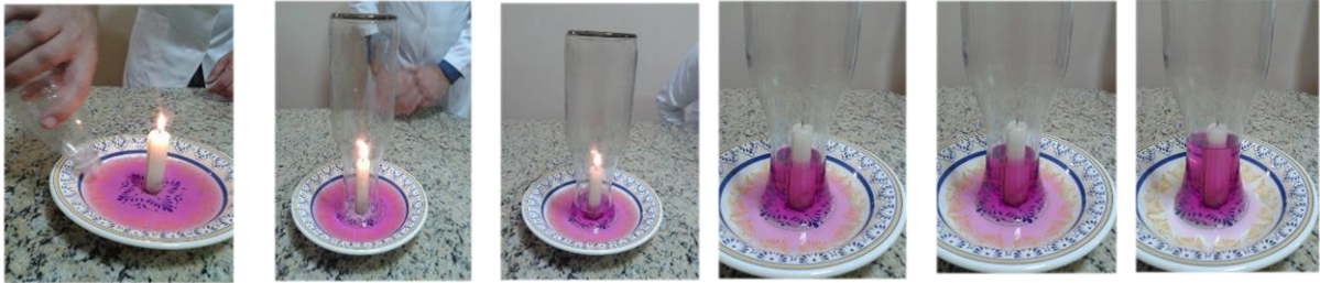
Figura 7 - Imagens da sequência da realização do experimento em que a água sobe para o interior da garrafa.
