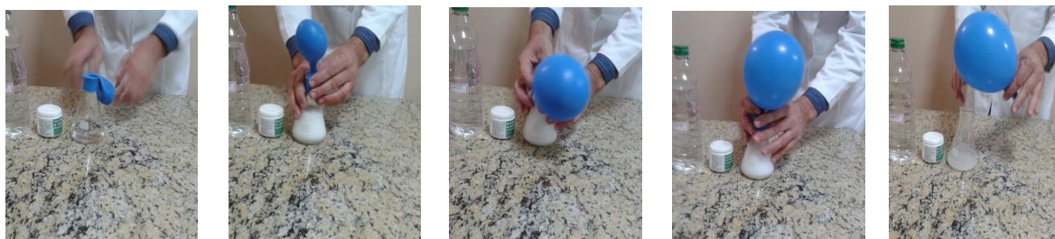
Figura 5 - Imagens da sequência do experimento onde observa-se que ocorre aumento do volume da bexiga devido a formação do gás carbônico (CO 2 ).
