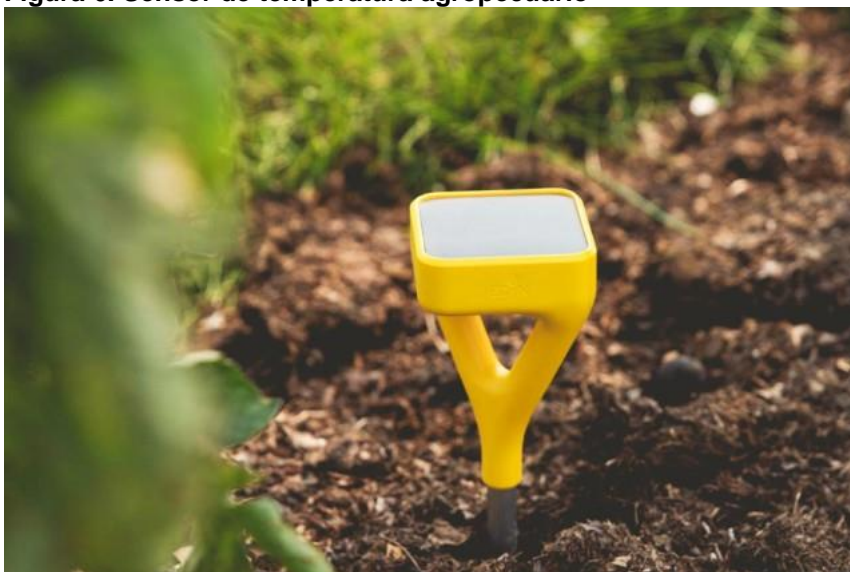
Figura 6. Sensor de temperatura agropecuário
