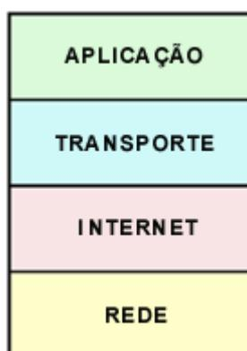
Figura 4 - Camada da Arquitetura TCP/IP
