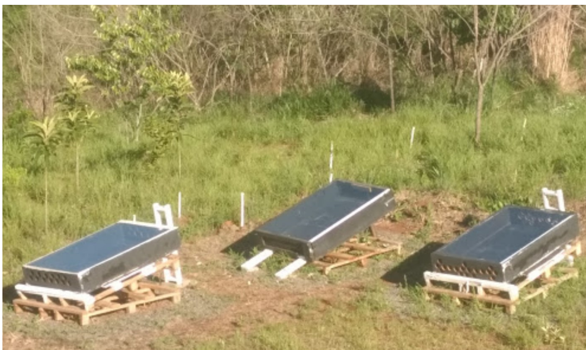
Figura 5: Secadores solares em MDF Naval (Fonte: Autoria própria, 2019)
