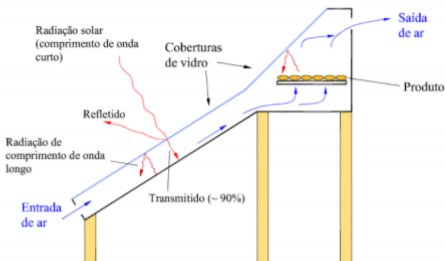
Figura 1: Constituição básica de um secador solar misto (Fonte: Silveira, 2011)
