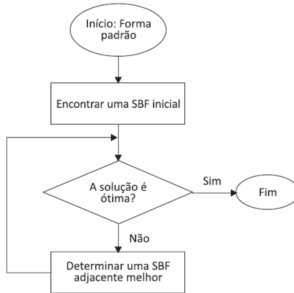
Figura 5 - Fluxograma da descrição geral do algoritmo Simplex
