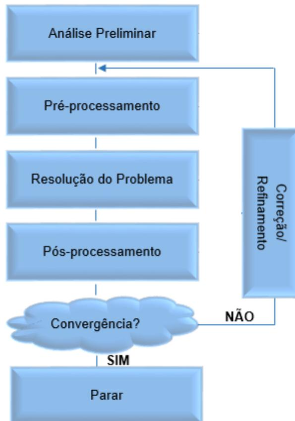
**Figura 16: Procedimento para desenvolvimento de um modelo em elementos finitos.**
