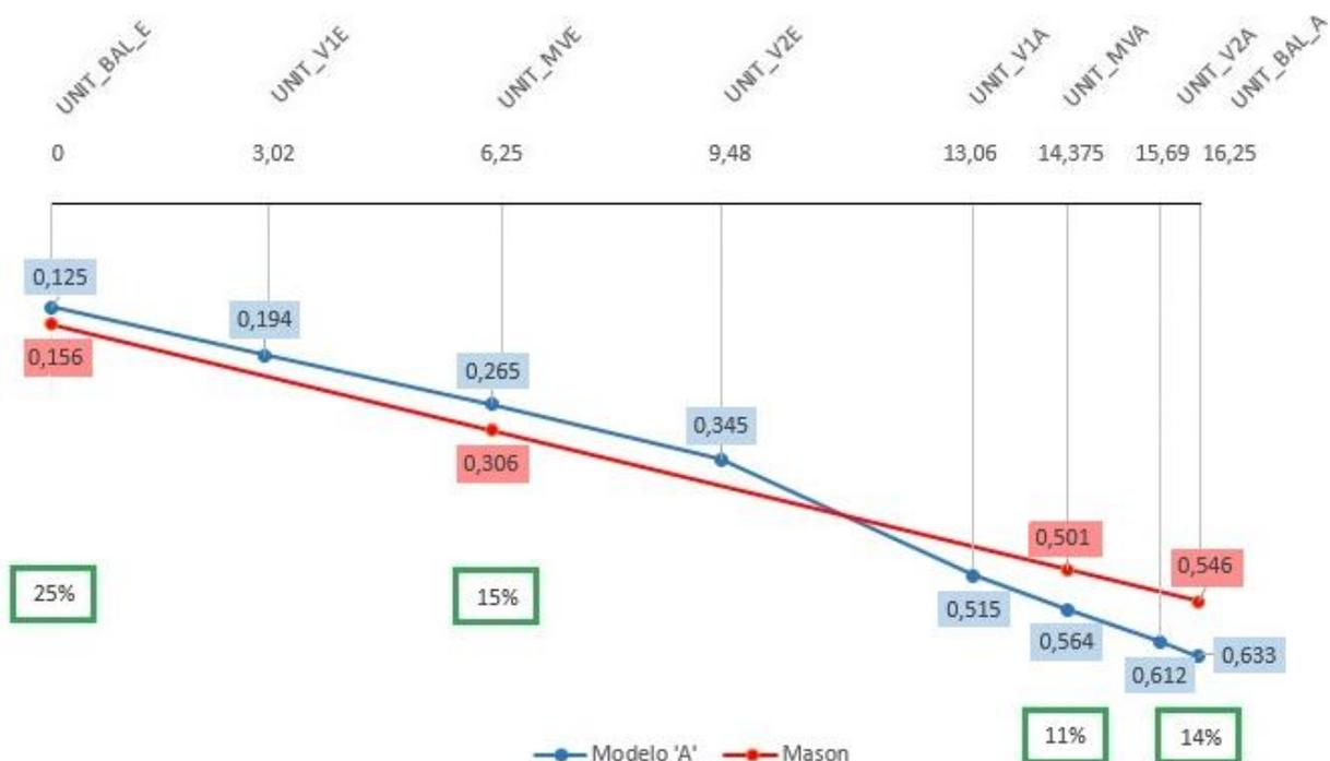
**Figura 83: Comparação entre a linha de influência da viga seção caixão de ampliação obtida do Modelo 'A' (em azul) e a linha de influência obtida do modelo baseado no Método de Mason (em vermelho).**
