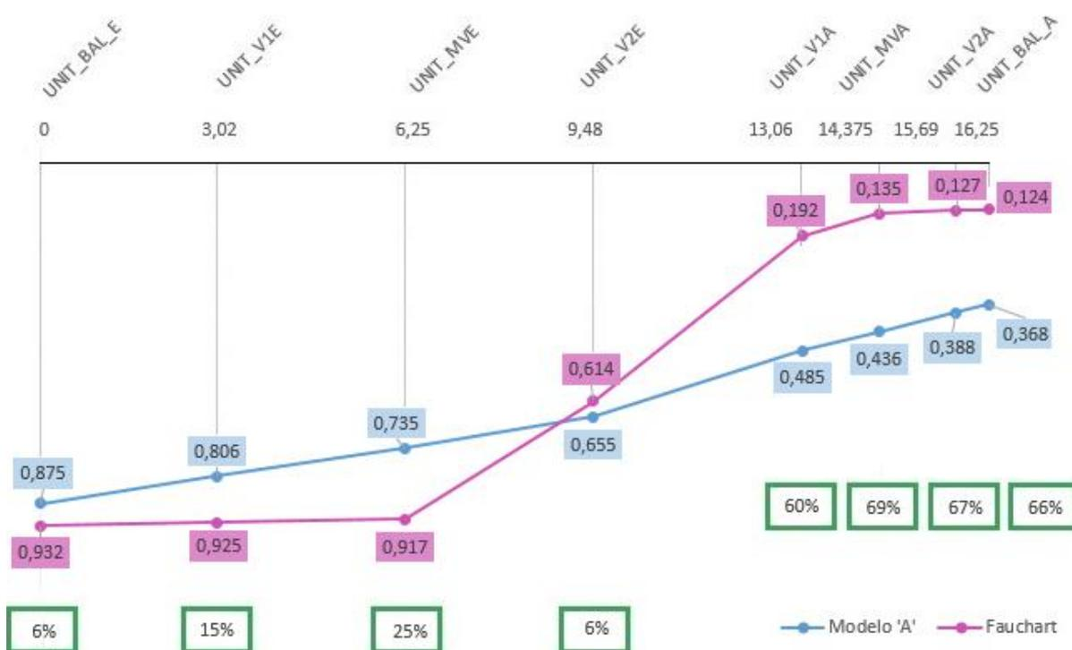
Figura 80: Comparação entre a linha de influência da viga seção caixão existente obtida do Modelo 'A' (em azul) e a linha de influência obtida do modelo baseado no Método de Fauchart (em lilás).
