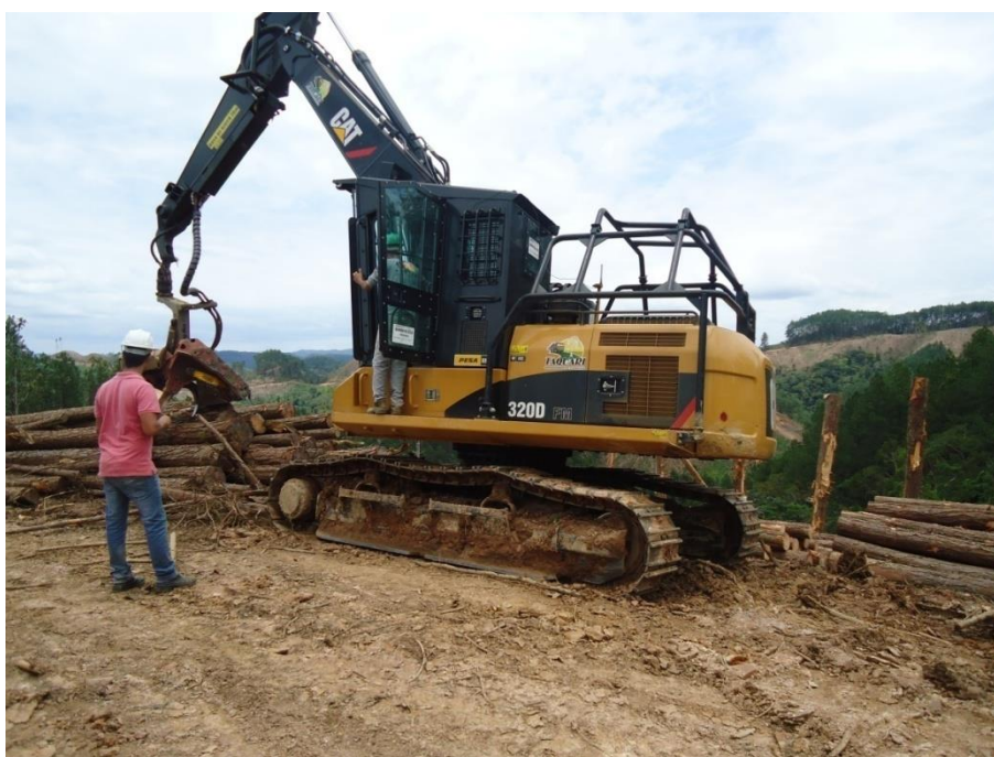
Figura14 - Escavadeira hidráulica adaptada com cabeçote processador
