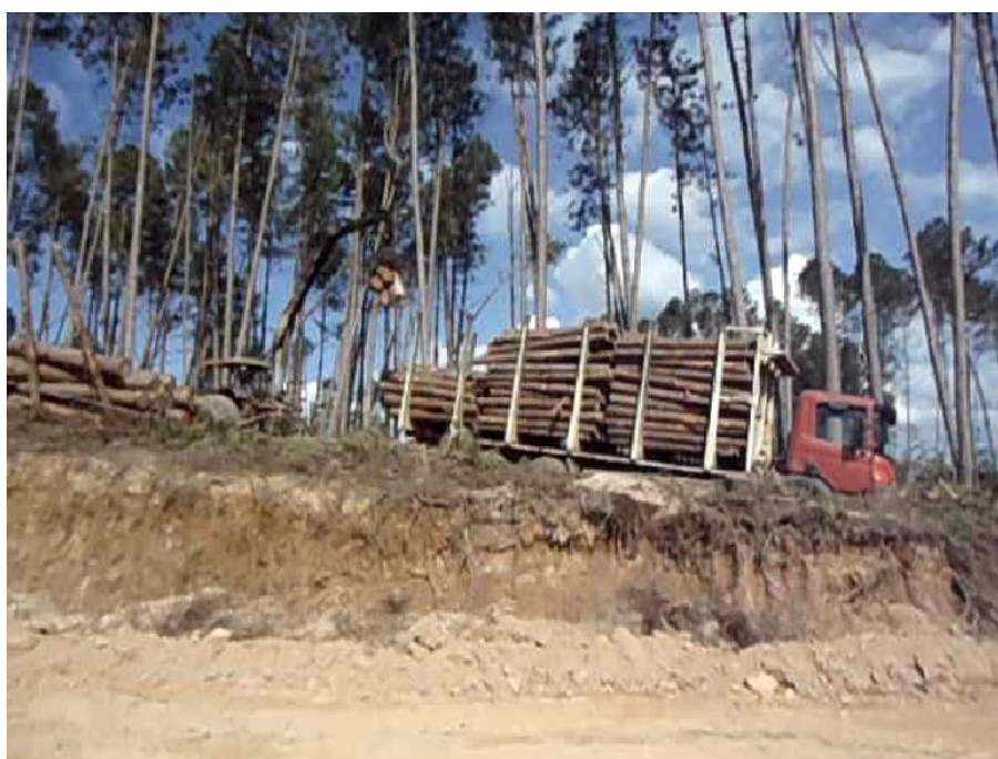
Figura 29 - Trator carregador de toras colocando-as no caminhão
