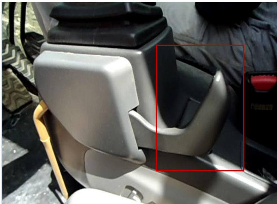
Figura 16 - Trava de acionamento
