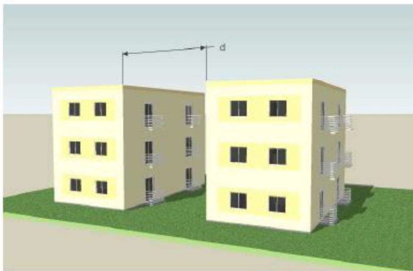
Figura 23 – Isolamento entre fachadas. Fonte: CSCIP/PR-(NPT-007/2015).
