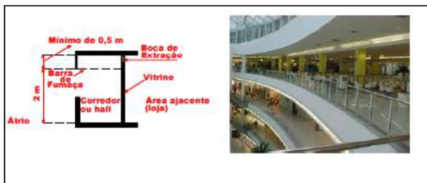
Figura 9 – Sistema de controle de Fumaça: Barreira de fumaça. Fonte: NPT-015-15 (2015).
