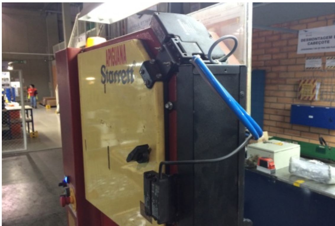
Figura 11 – Imagem Local – Portas de acesso Serra Fita (DEPOIS DA ADEQUAÇÃO) Fonte: EOLD
