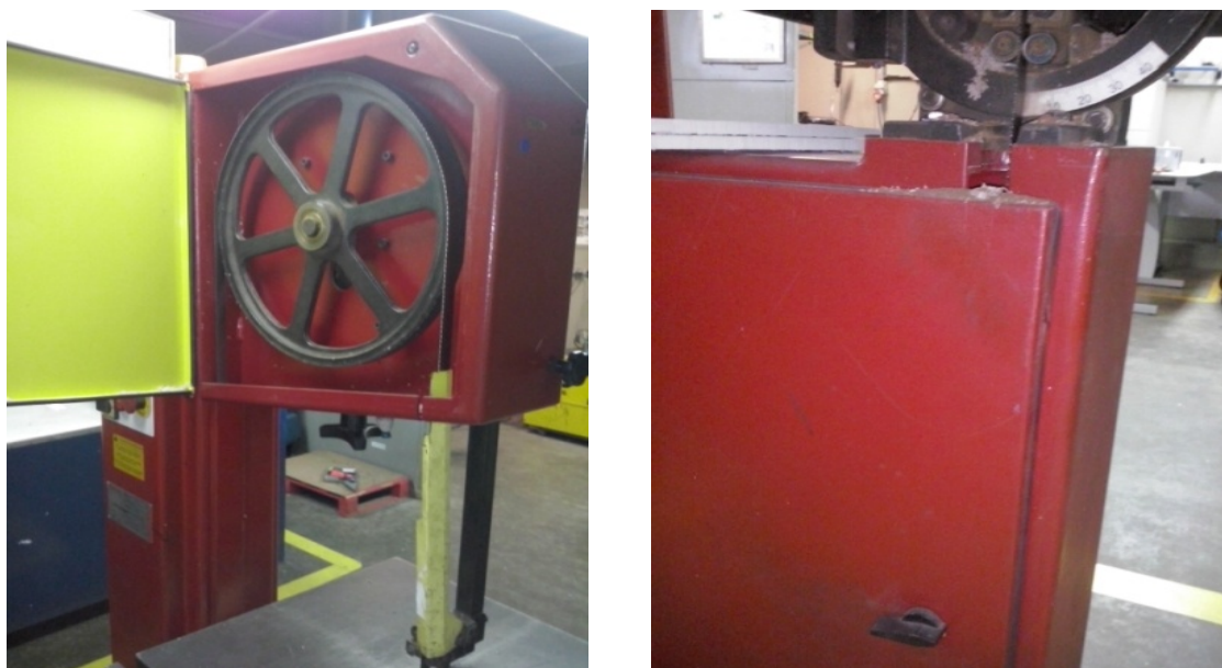
Figura 10 – Imagem Local – Portas de acesso Serra Fita (ANTES DA ADEQUAÇÃO)
