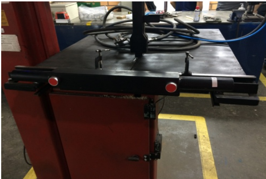
Figura 16 – Detalhes Proteção da Zona de Perigo - Mesa (DEPOIS DA ADEQUAÇÃO) Fonte: EOLD
