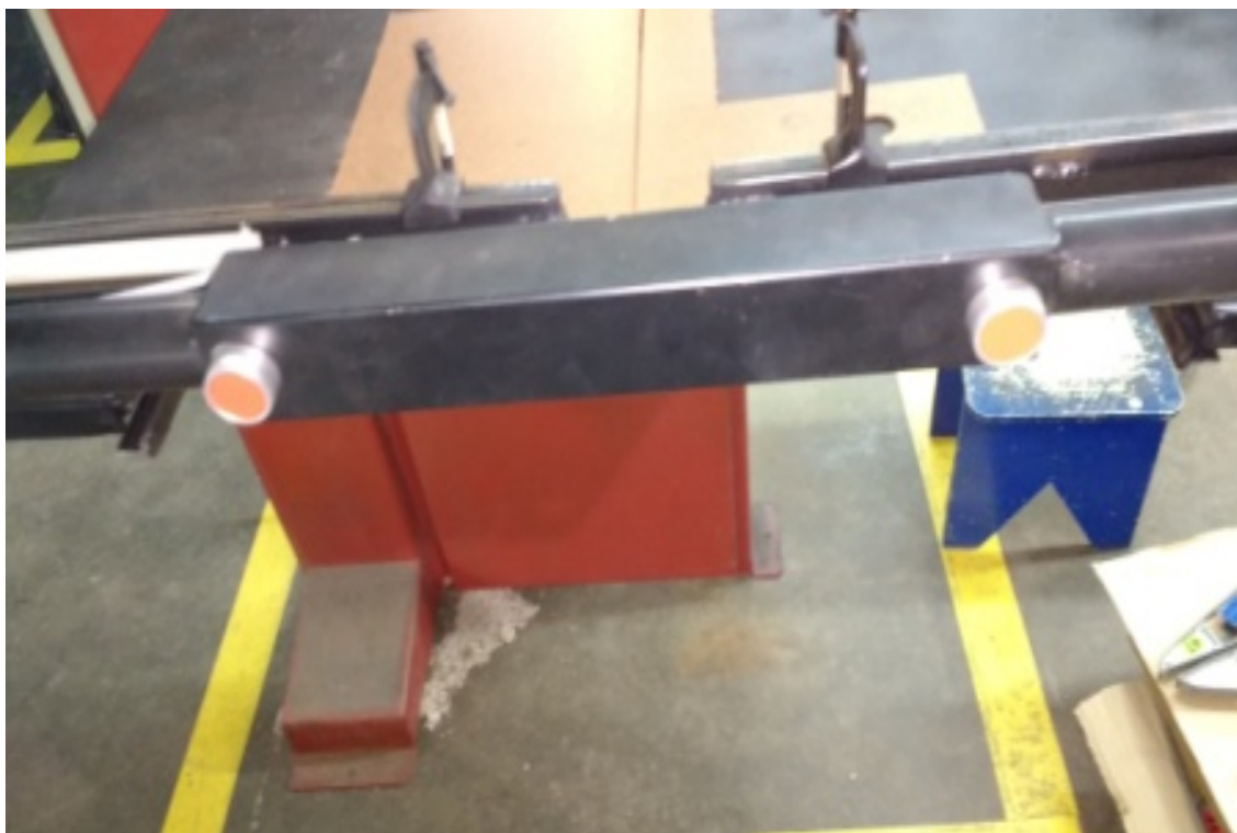
Figura 17 – Proteção da Zona de Perigo – Comando Bi Manual (DEPOIS DA ADEQUAÇÃO) Fonte: EOLD
