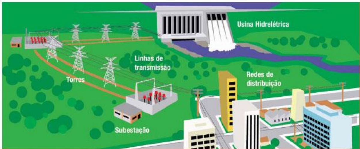
Figura 1 - Sistema de geração, transmissão e distribuição de energia elétrica Fonte: UEPB (2008).
