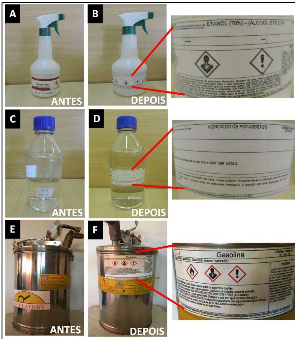
Figura 10. Exemplos de recipientes rotulados em conformidade com o GHS. A e B, Burrifador com solução de Álcool Etilico 70%; C e D, Garrafa Schott com solução de Hidróxido de Potássio 2%; E e F, Container para inflamáveis com gasolina.
