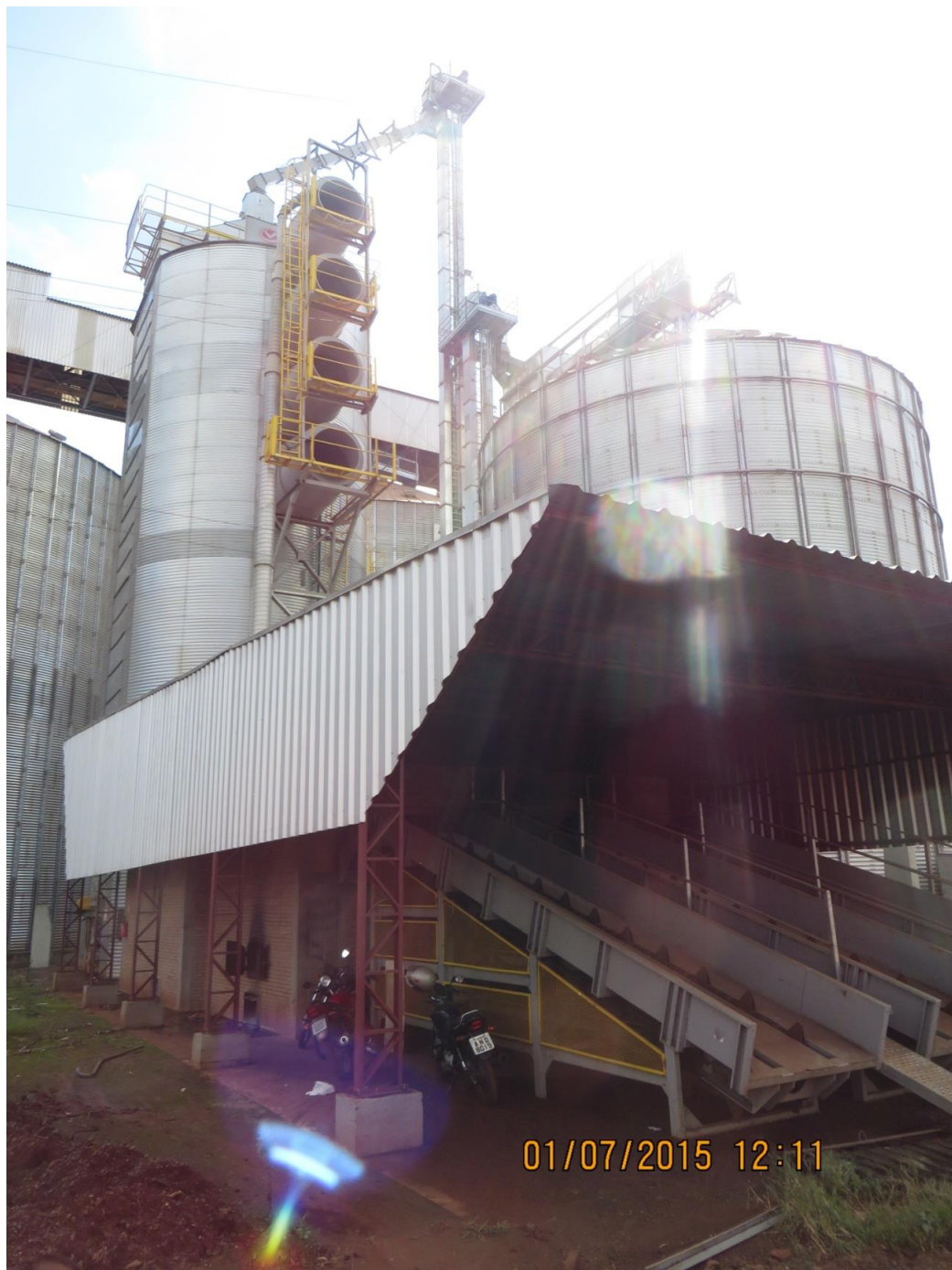
Figura 5 - Fornalha e secador de grãos Fonte: Arquivo pessoal empresa estudada.
