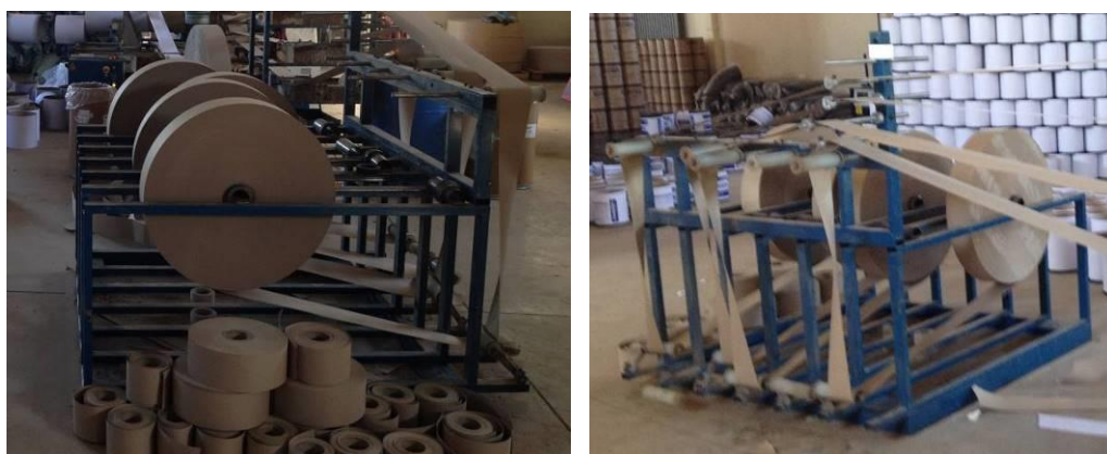
Figuras 34 e 35 – Estaleiro para encaixe e posicionamento das bobinas de papel. Fonte: O autor (2017).
