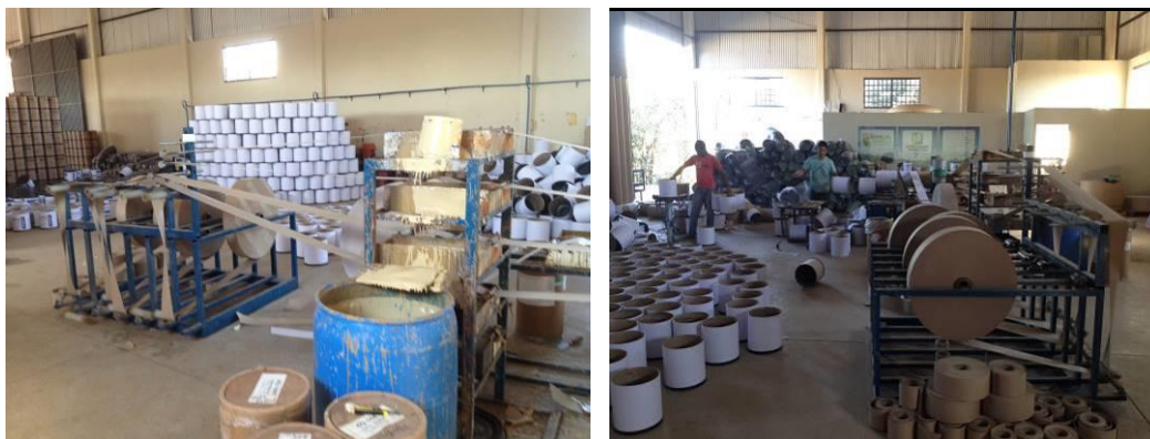
Figuras 8 e 9 – Bobinas de papel kraft dispostas na máquina que produz os tubos de papelão. Fonte: O autor (2017).
