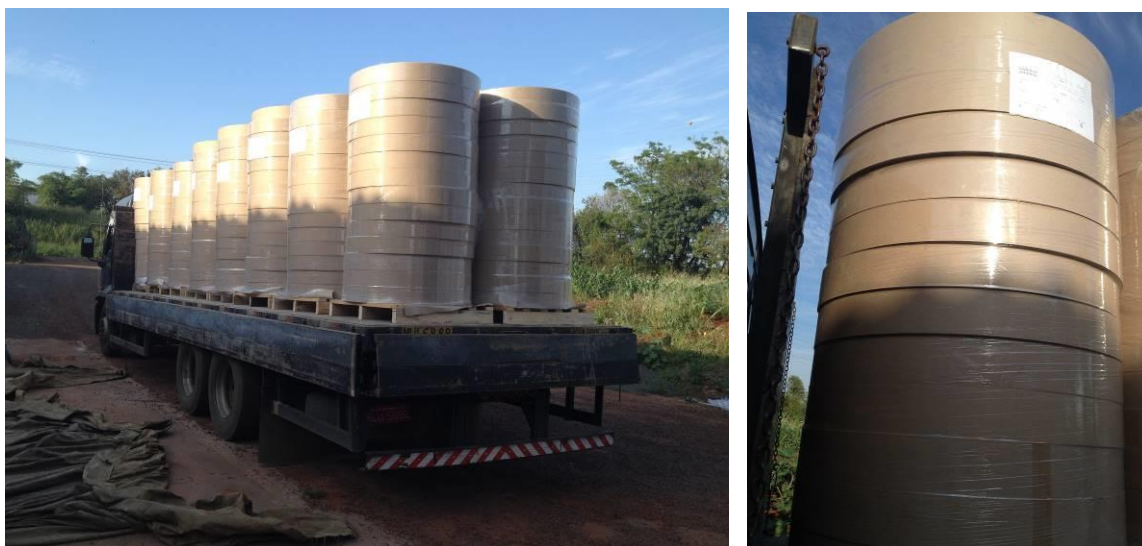
Figuras 28 e 29 – Bobinas de papel paletizadas e desalinhadas com caminhão sobre terreno irregular.
