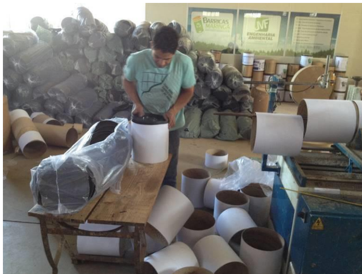
Figura 16 – Encaixe do fundo de polipropileno no tubo de papelão. Fonte: O autor (2017).
