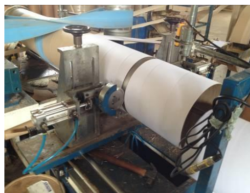
Figuras 39 e 40 – Sistema de corte pneumático do tubo de papel com acionamento por sensor. Fonte: O autor (2017).
