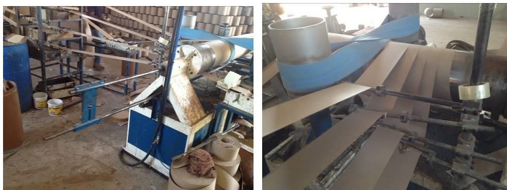
Figuras 41 e 42 - Máquina tubeteira em operação com a correia plana que traciona o papel. Fonte: O autor (2017).
