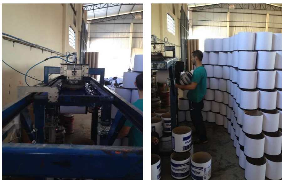
Figuras 45 e 46 – Impressora serigráfica com acionamento pneumático. Fonte: O autor (2017).
