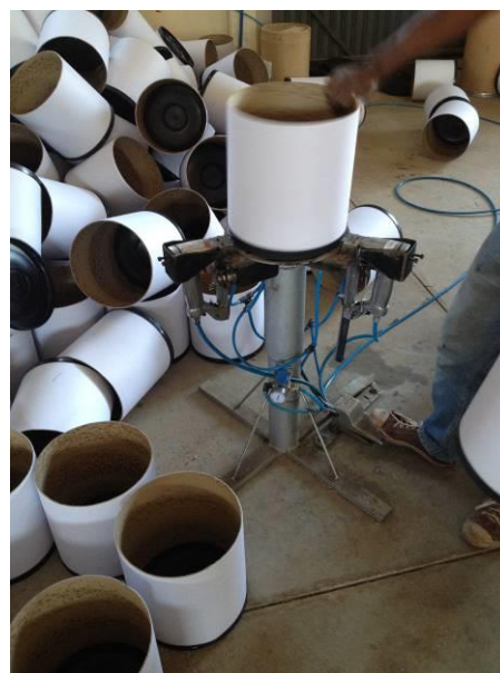
Figuras 17 e 18 – Grampeador pneumático de 03 pontos com acionamento por pedal. Fonte: O autor (2017).
