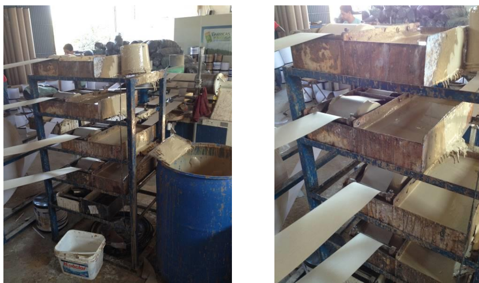
Figuras 10 e 11– Faixas de papel kraft passando pelo sistema de cola. Fonte: O autor (2017).
