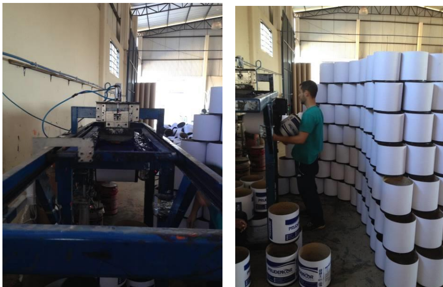
Figuras 19 e 20 – Impressora Silk pneumática com acionamento por pedal. Fonte: O autor (2017).
