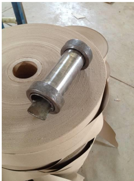
Figura 36 – Cilindro metálico utilizado para encaixe das bobinas no estaleiro. Fonte: O autor (2017).
