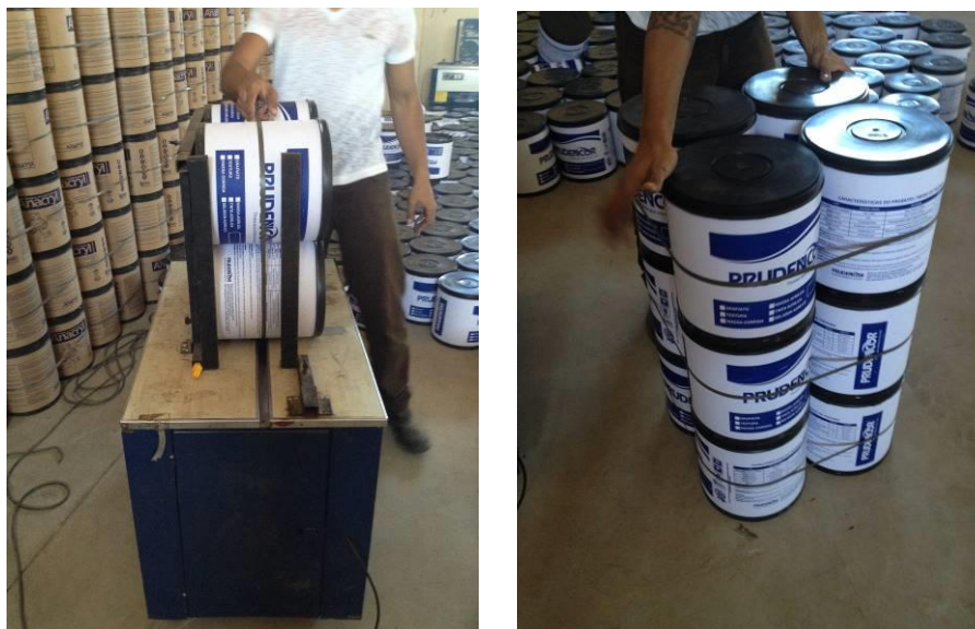
Figuras 21 e 22 – Máquina de arquear e empilhamento do produto acabado. Fonte: O autor (2017).
