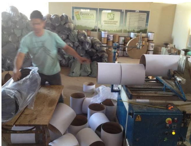
Figura 37 - Funcionário responsável pela operação da tubeteira de papel, realizando o encaixe de fundos plásticos. Fonte: O autor (2017).
