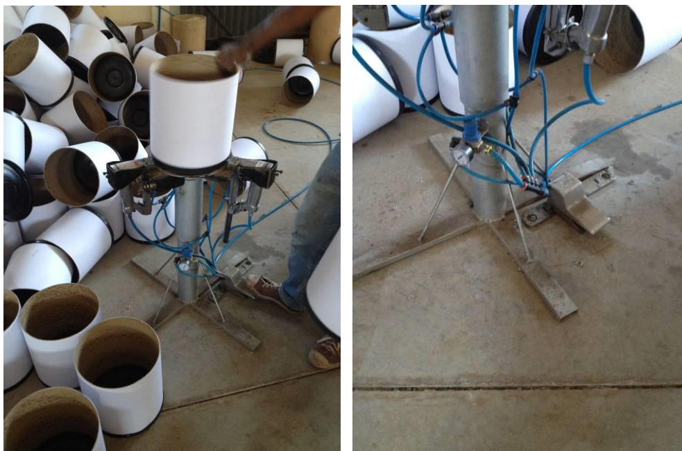
Figuras 43 e 44 – Grampeador pneumático de 03 (três) pontos com acionamento por pedal. Fonte: O autor (2017).
