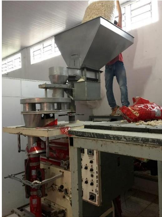
**Figura 21 – Alimentação manual do funil da prensa embaladora Inbramaq 60**
