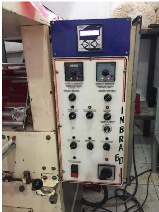
**Figura 20 – Painel de controle da prensa embaladora Inbramaq 60**
