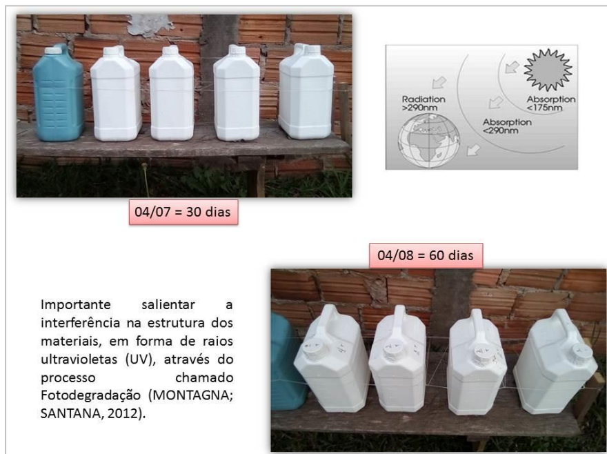
Figura 15: Exposição das embalagens aos Raios UV no período de 30 e 60 dias Fonte: Autoria própria
