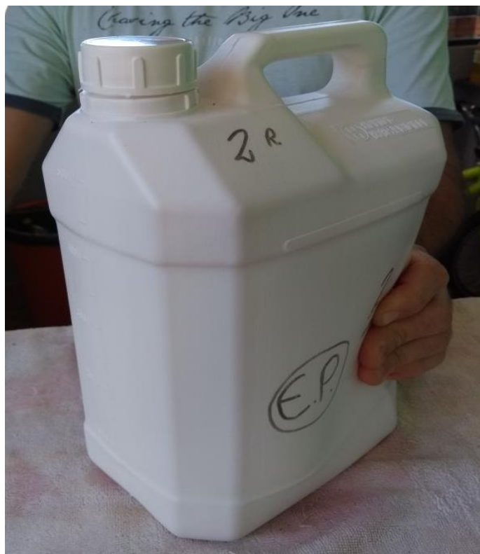
Figura 39: 2º Ensaio de estanqueidade com embalagens protegidas sem UV Fonte: Autoria própria
