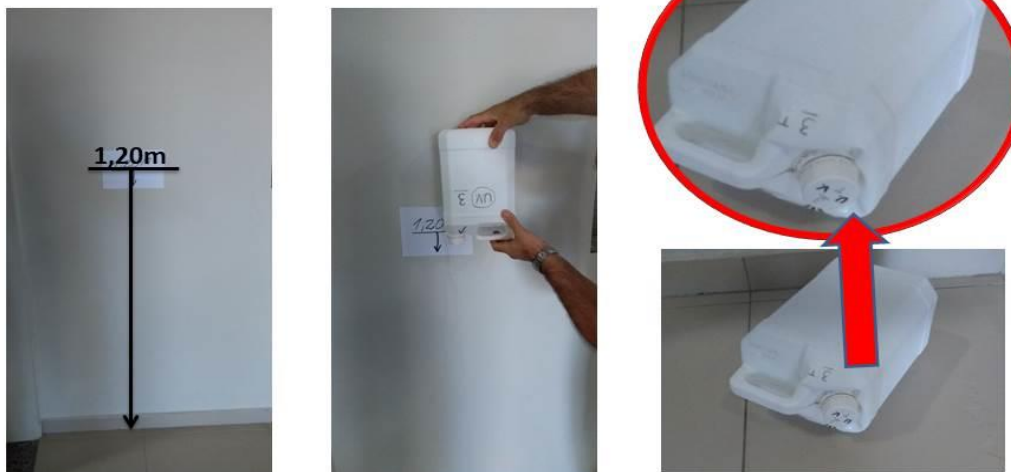
Figura 27: Ensaio referente a tampa, rosca e costura da alça da embalagem com UV Fonte: Autoria própria
