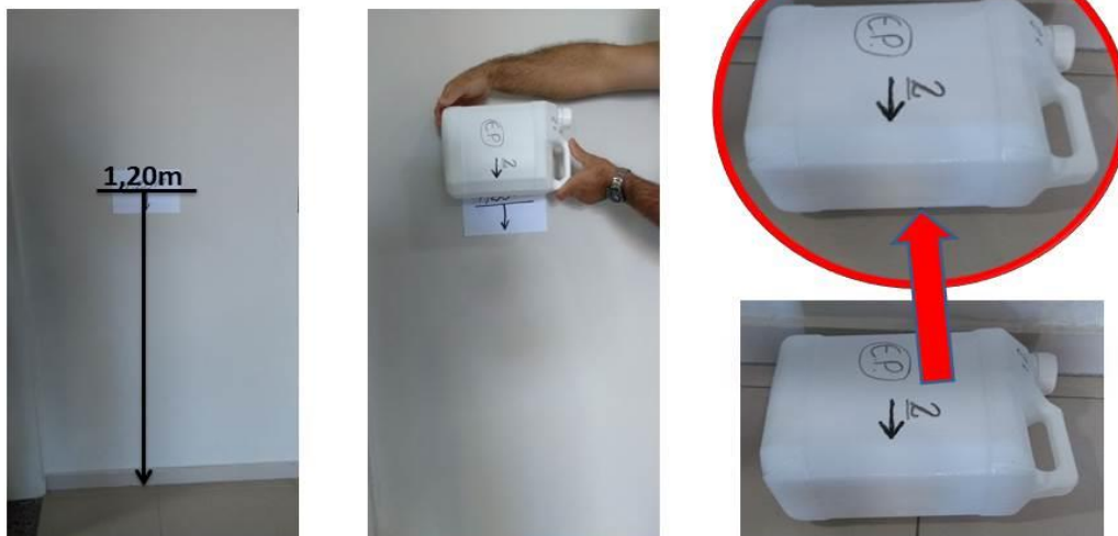
Figura 30: Ensaio referente à costura lateral do molde da embalagem sem UV Fonte: Autoria própria
