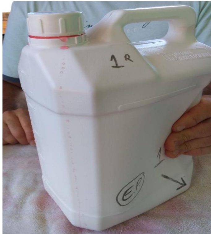
Figura 38: 1º Ensaio de estanqueidade com embalagens protegidas sem UV Fonte: Autoria própria
