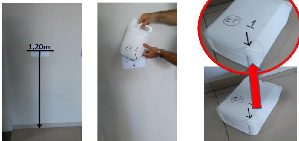
Figura 29: Ensaio referente à costura diagonal do fundo do molde sem UV Fonte: Autoria própria
