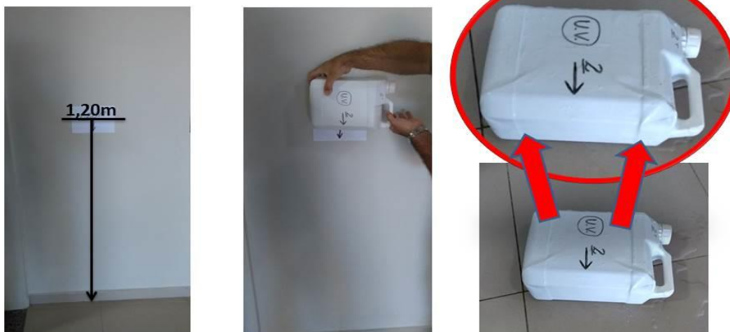
Figura 25: Ensaio referente à costura lateral do molde da embalagem com UV Fonte: Autoria própria
