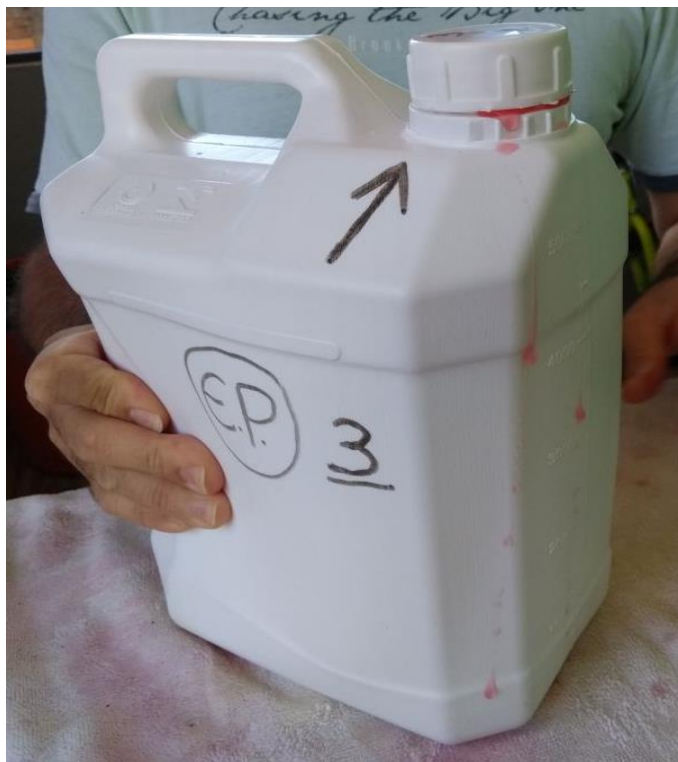
Figura 40: 3º Ensaio de estanqueidade com embalagens protegidas sem UV Fonte: Autoria própria
