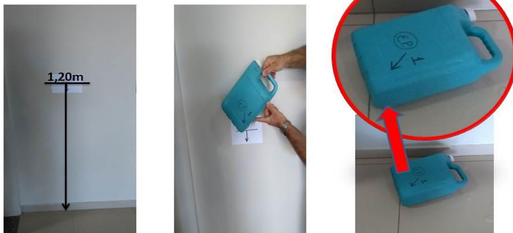
Figura 32: Ensaio referente a costura diagonal do fundo do molde, embalagem sem UV Fonte: Autoria própria
