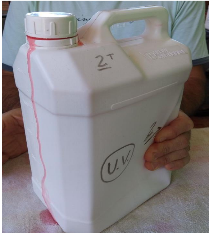
Figura 35: 2º Ensaio de estanqueidade com embalagens expostas ao UV Fonte: Autoria própria
