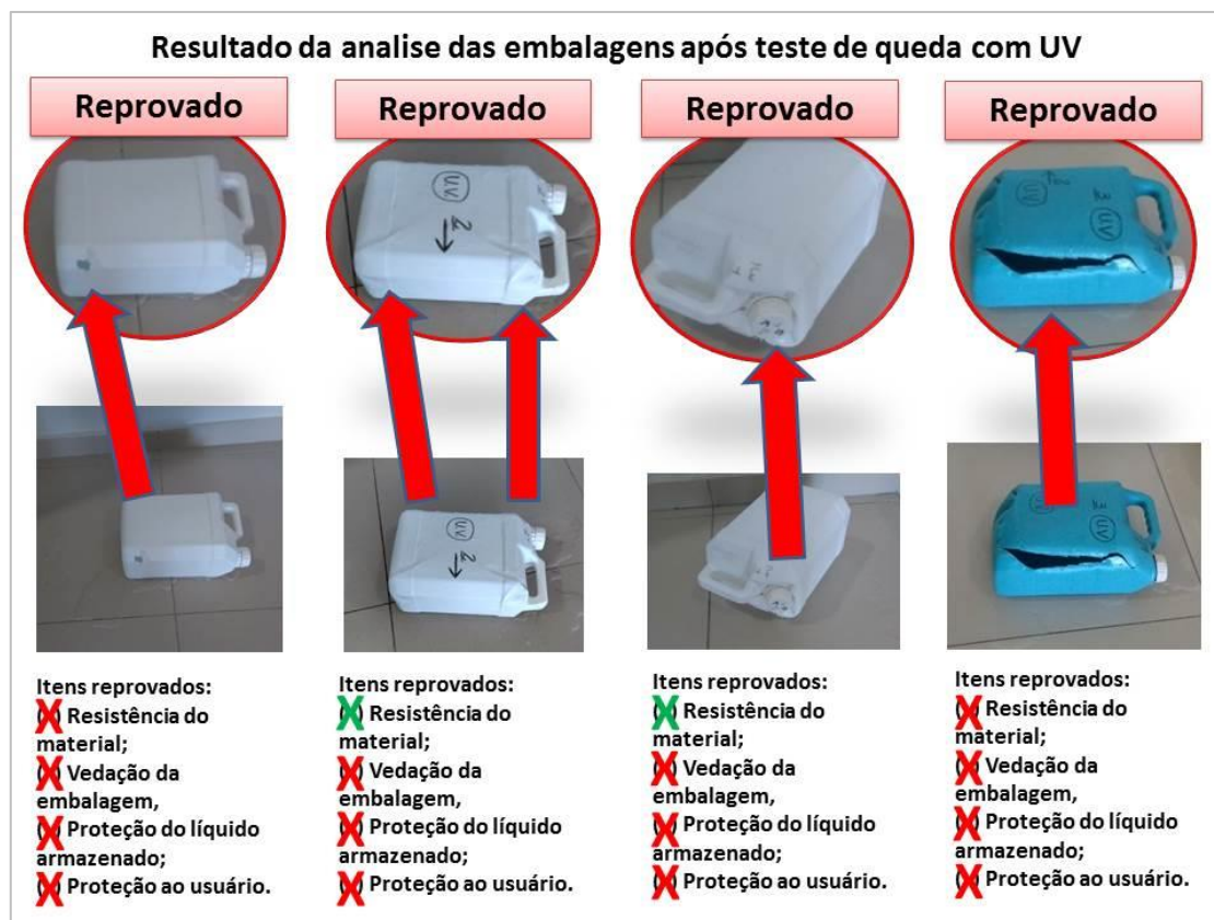
Figura 42: Resultados da análises das embalagens após testes de queda com UV Fonte: Autoria própria
