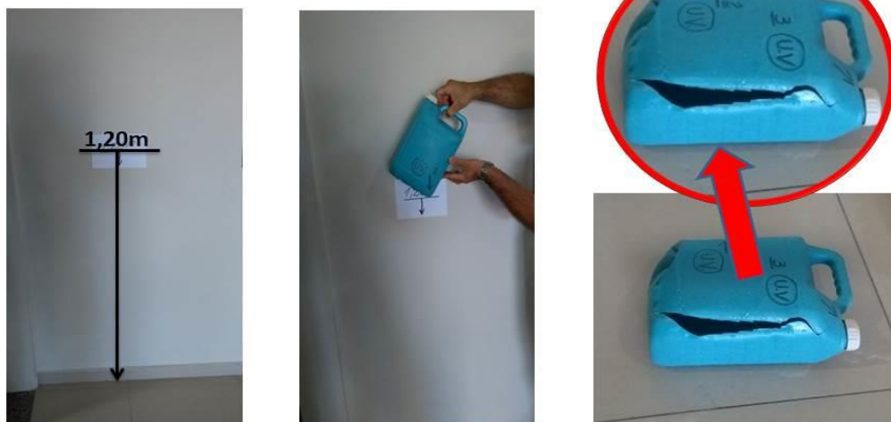
Figura 28: Ensaio referente a costura diagonal do fundo do molde, embalagem com UV Fonte: Autoria própria
