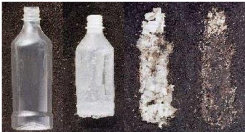
Figura 13: Degradação de embalagem por agentes químicos Fonte: https://steemit.com
