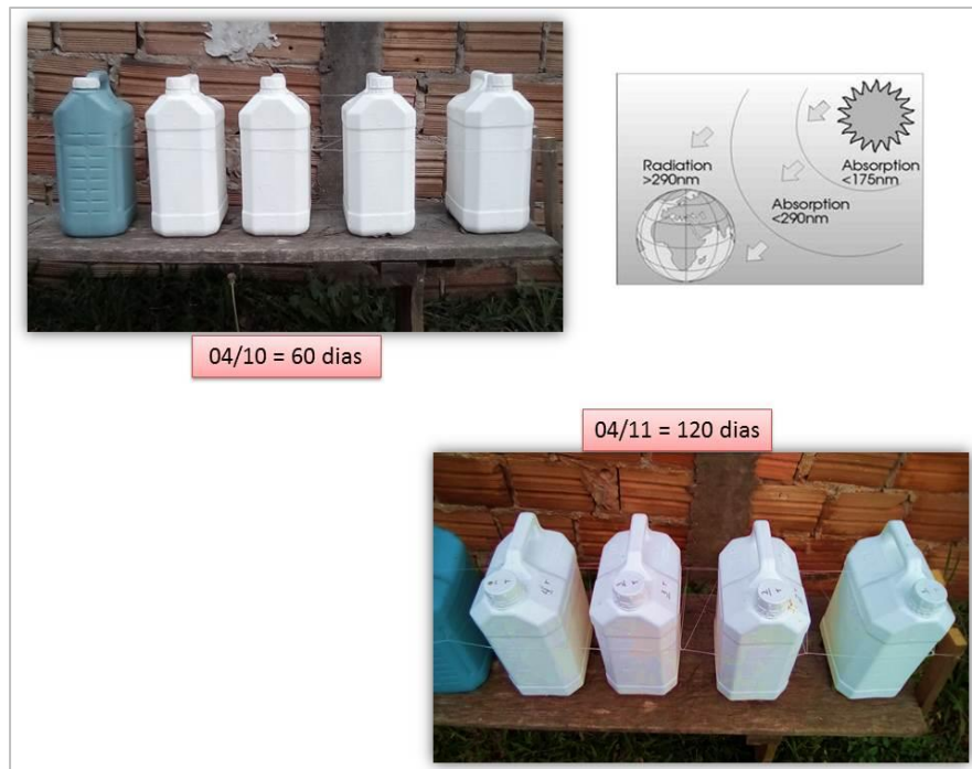
Figura 16: Exposição das embalagens aos Raios UV no período de 90 e 120 dias Fonte: Autoria própria
