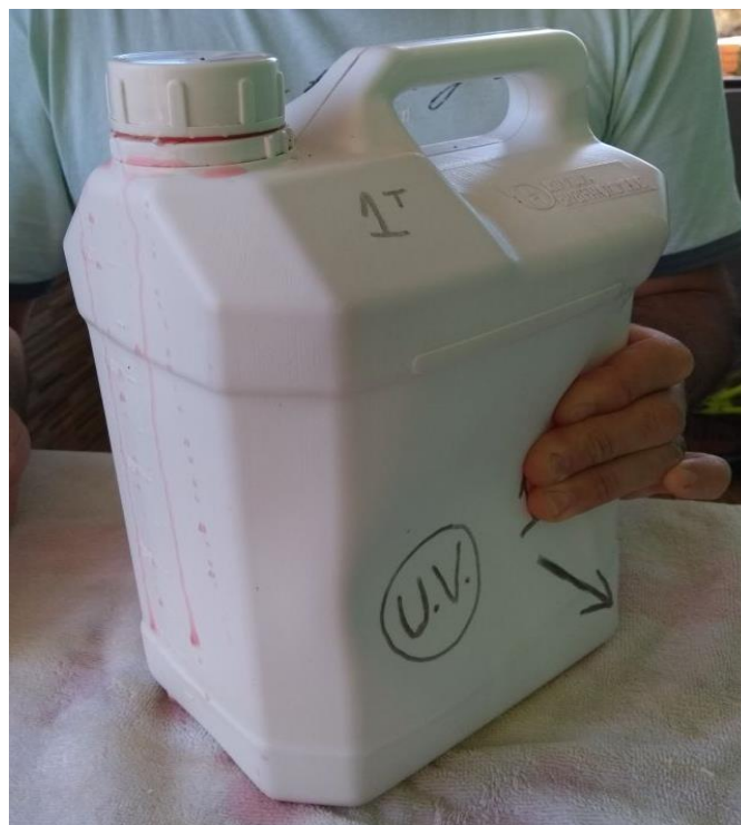
Figura 34: 1º Ensaio de estanqueidade com embalagens expostas ao UV Fonte: Autoria própria
