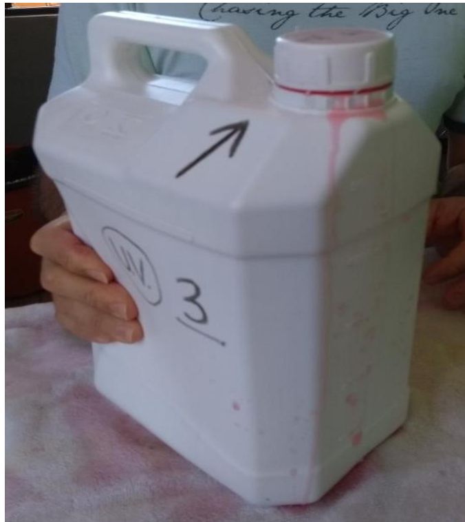
Figura 36: 3º Ensaio de estanqueidade com embalagens expostas ao UV Fonte: Autoria própria
