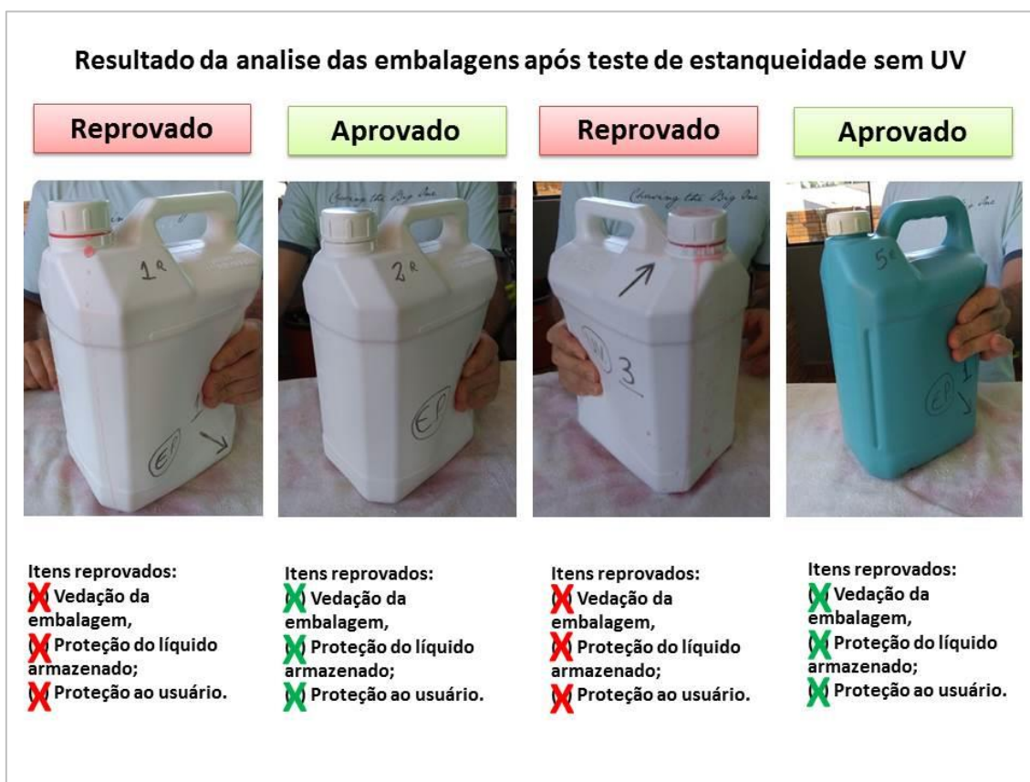
Figura 45: Resultados da análises das embalagens após teste de queda sem UV Fonte: Autoria própria
