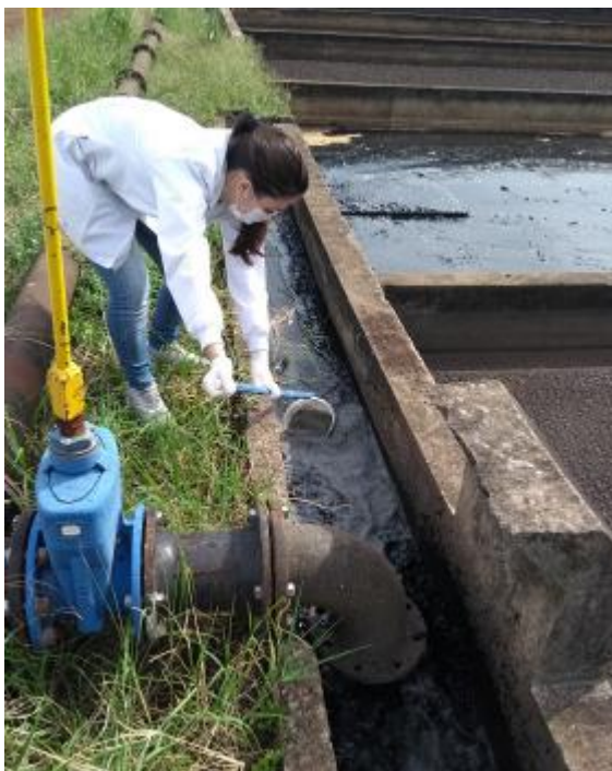
Figura 5 - Coleta de amostra de lodo em uma Estação de Tratamento de Esgoto da cidade de Londrina.
