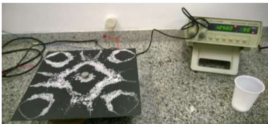
Fotografia 2 - Figura gerada com o uso do gerador de sinais. Fonte: Autor professor Me. Everton Botan.
