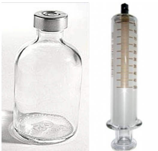
Figura 1 – Frasco de vidro para teste de PME (a) e seringa para medição do biogás (b)
