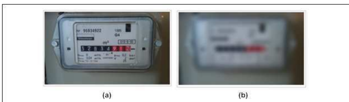
Figura 10. Aplicação do filtro Gaussiano. (a) Imagem original; (b) Imagem filtrada ( \sigma = 7 ).
