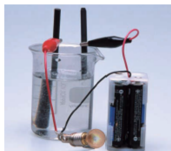
Figura 6.9 A condutividade elétrica dos materiais não pode ser explicada por nosso modelo de partículas.
