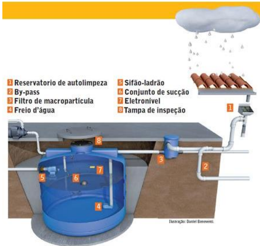
Fonte: Tomaz (2003). Figura 1 – Esquema de captação de água.
