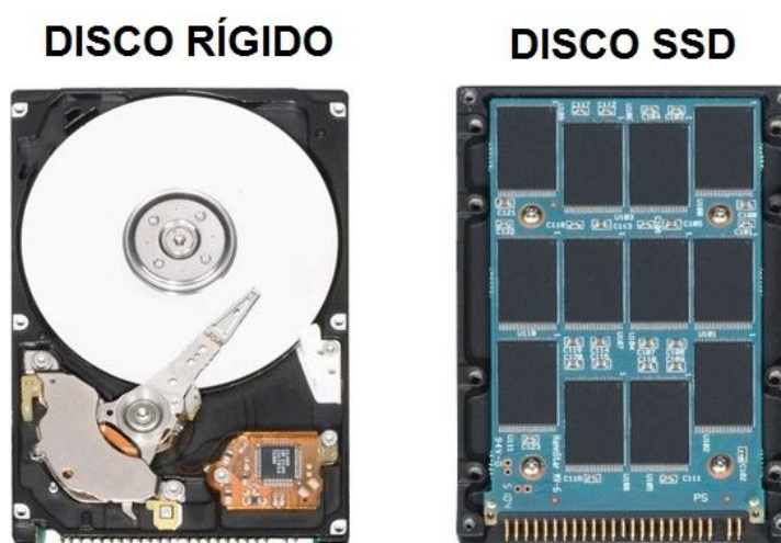
Figura 1: Comparativo Disco Rígido x SSD.
