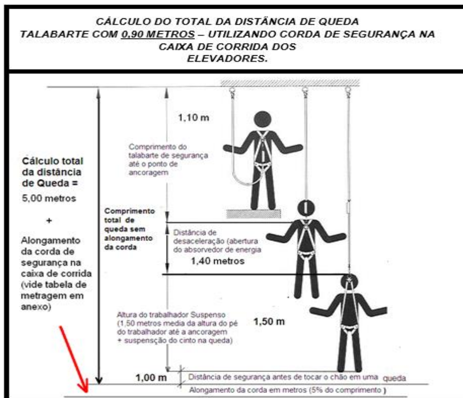
Figura 20: Cálculo da distância de queda para talabarte com 0,90 metros Fonte: Thyssenkrupp Elevadores
