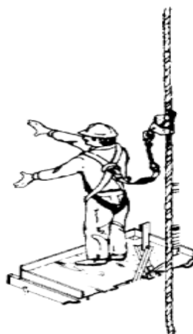
Figura 24: Instalação da trava queda acima da cabeça do usuário. Fonte: Thyssenkrupp Elevadores
