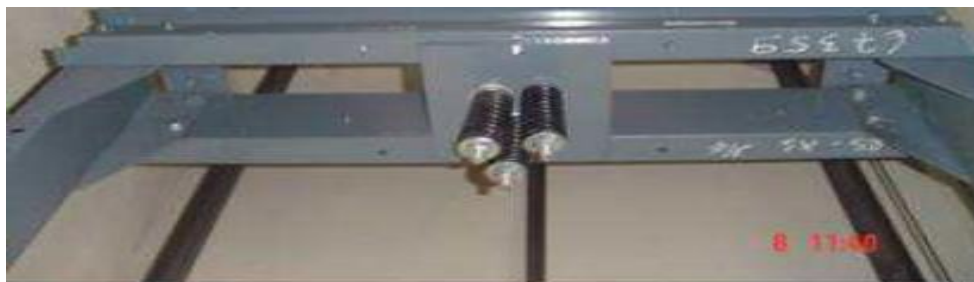
Figura 33: Tirantes fixados na estrutura superior da cabine.
