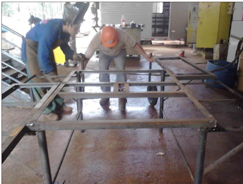
Figura 7: Metalúrgicos trabalhando na confecção da bancada.
