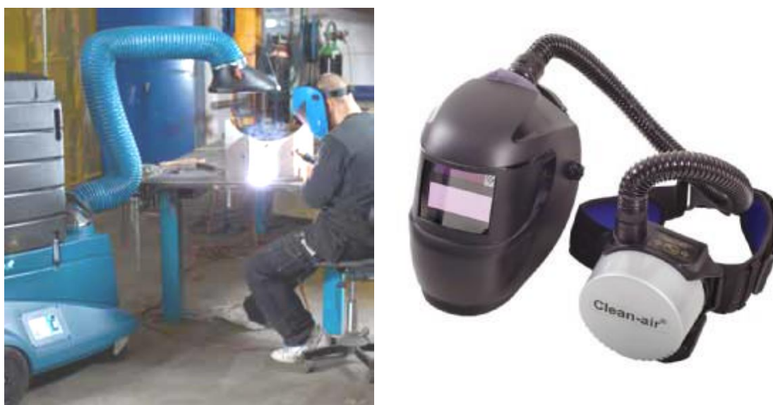
Figura 37 – Sistema de captação móvel para fumos e gases (esquerda) e máscara com proteção respiratória.
