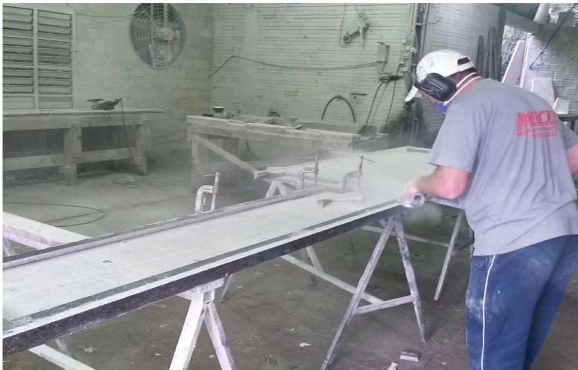
**Figura 12: Polimento das aristas e lixamento das bordas**
