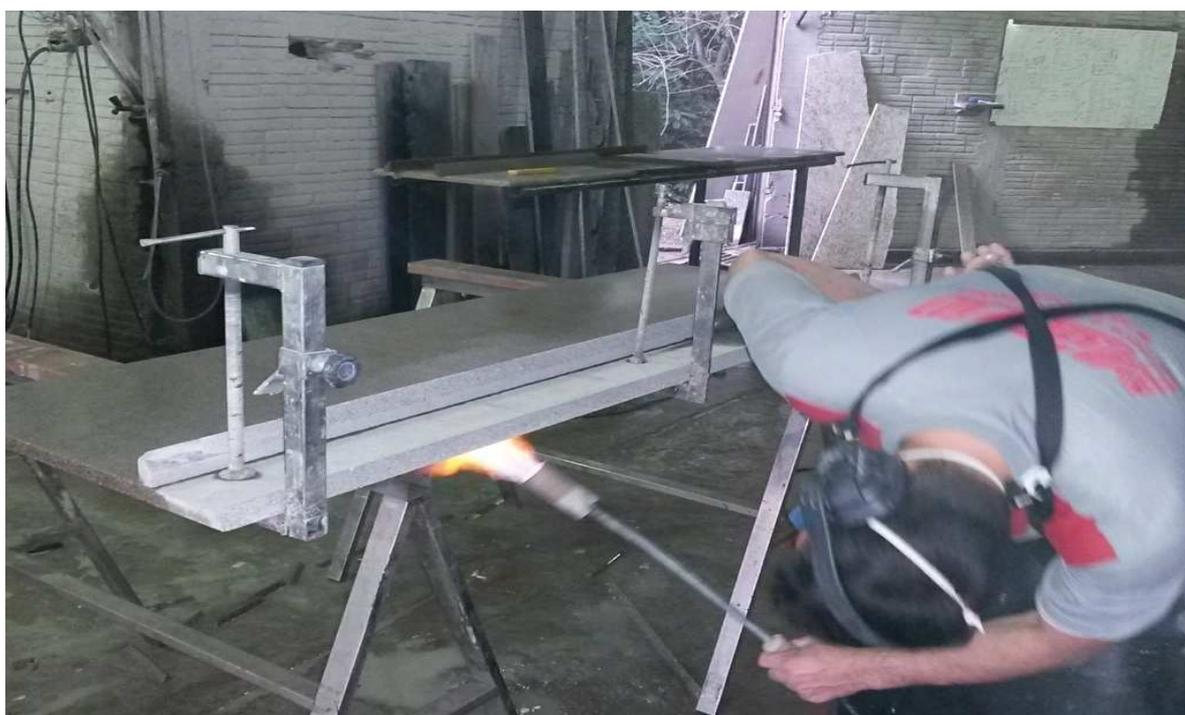
**Figura 13: Secagem das peças de granito**
