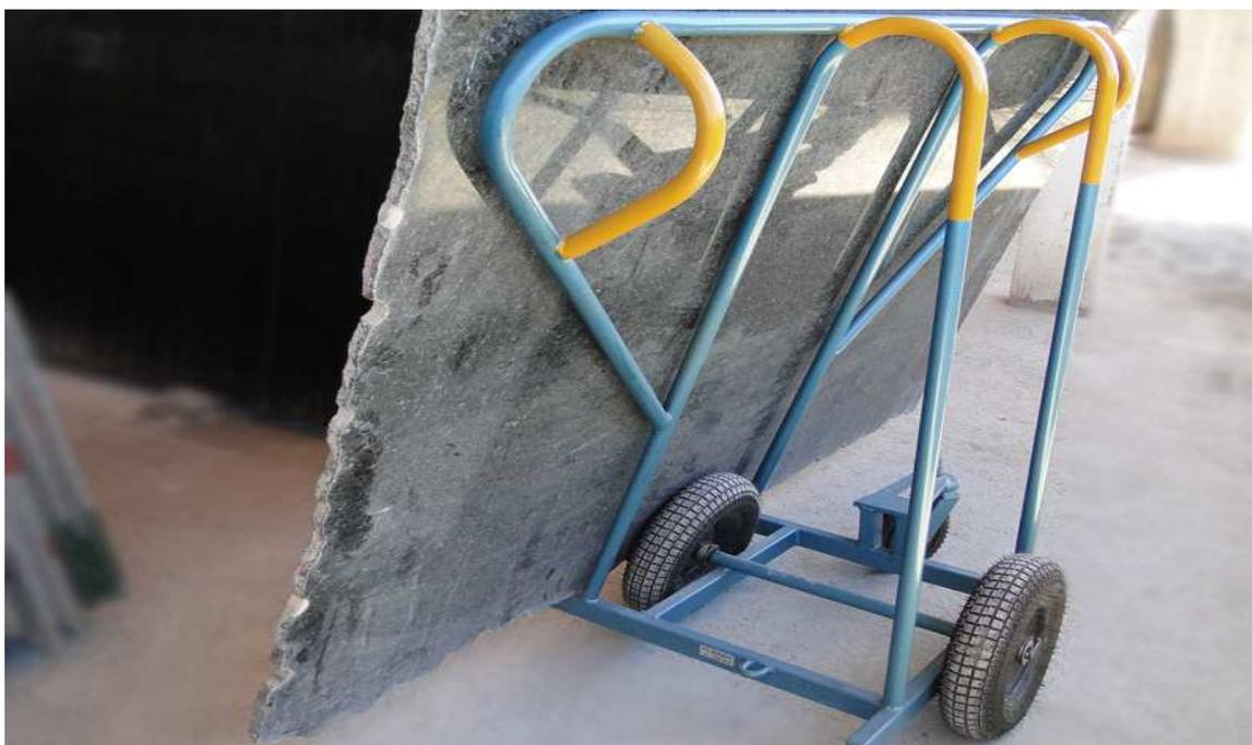
**Figura 17: Carro para transporte vertical das rochas**
