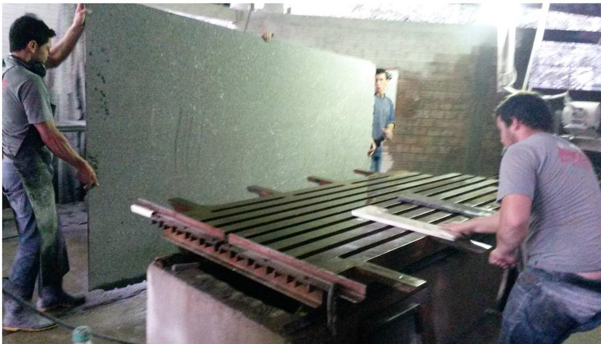
**Figura 8: Posicionamento das chapas na mesa de corte**
