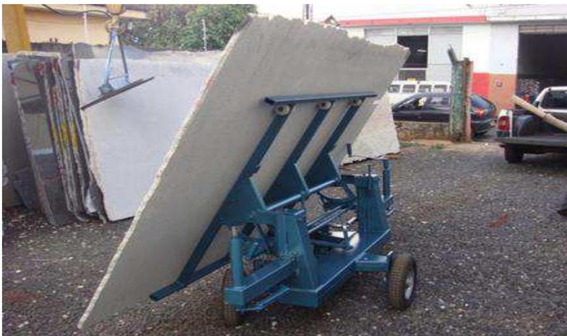
**Figura 18: Carro transportador (1)**
