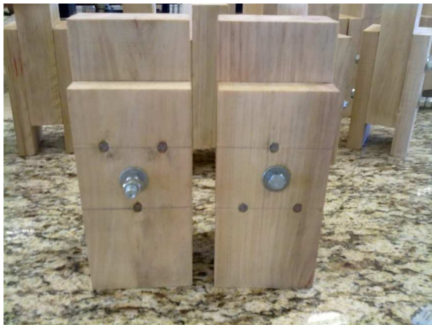
Figura 12 – Forma aparente de faces opostas na ligação Mista.
