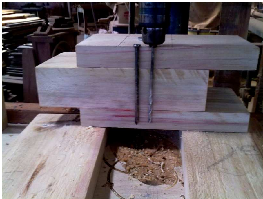
Figura 9 – Demonstração do alcance da pré-furação e do prego
