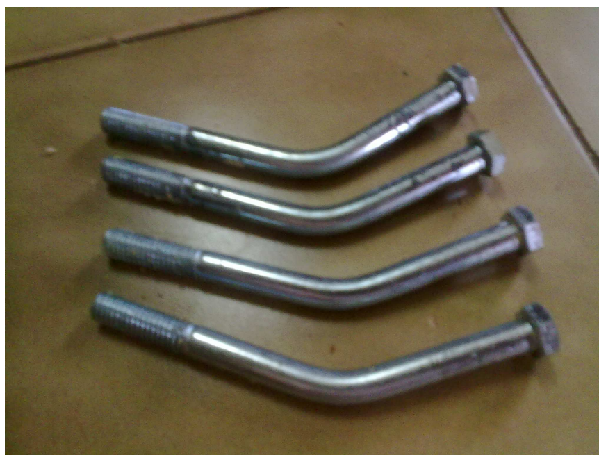
Figura 13 – Estados dos parafusos após ensaio.
