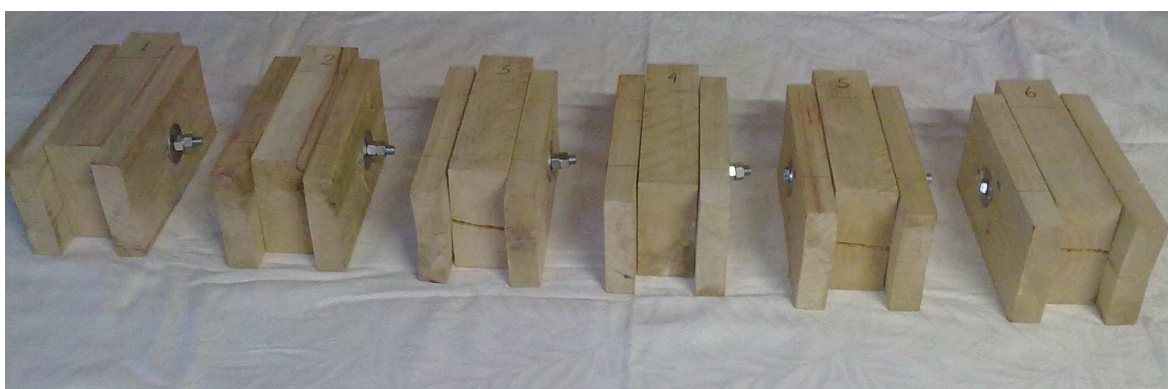
Figura 15 – Amostras de ligação mista após ensaio.
