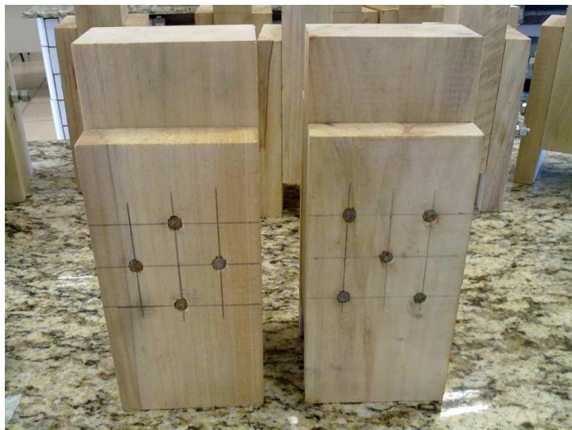
Figura 8 – Forma aparente de faces opostas na ligação pregada
