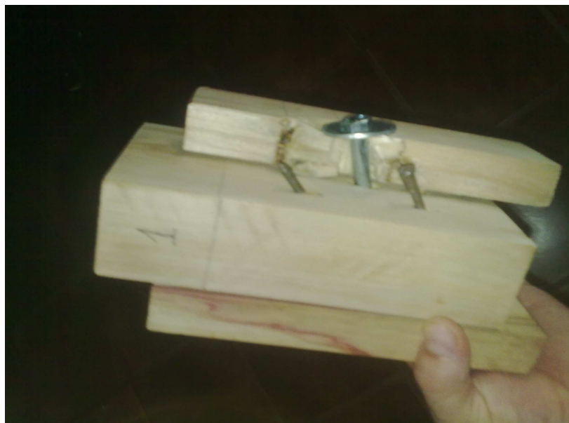
Figura 16 – Pinos metálicos da ligação mista após ensaio.
