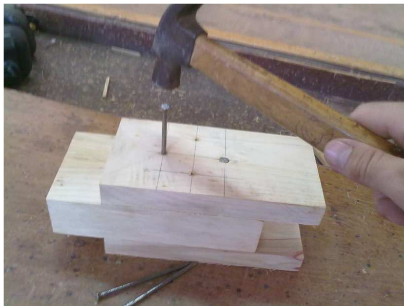
Figura 10 – cravação do prego após pré-furação
