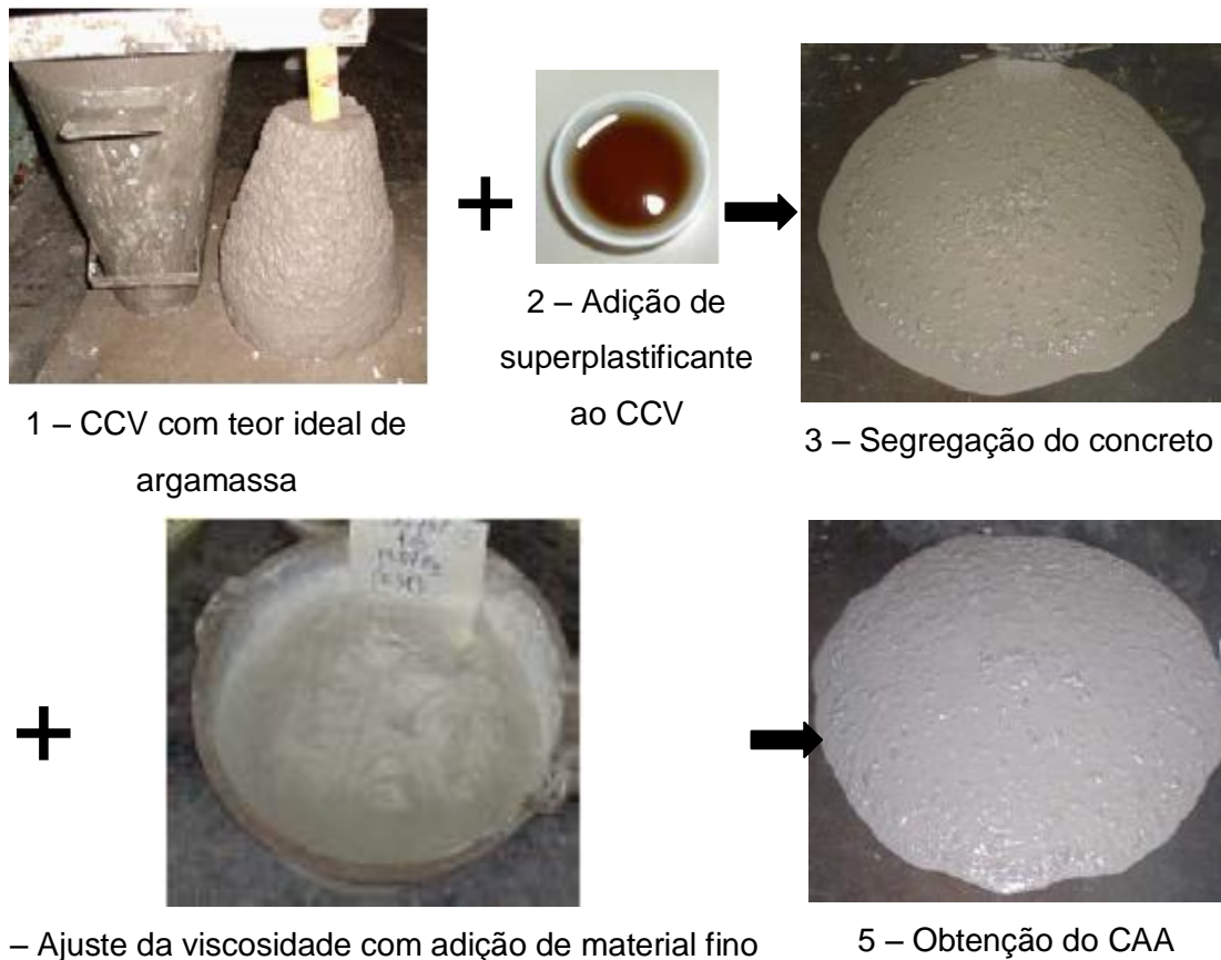
Figura 7: princípio básico do método proposto por Tutikian (2004)
