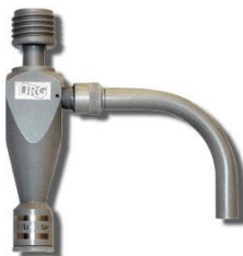
Figura 10: Ciclone 2000-30 E H utilizado na amostragem externa.
