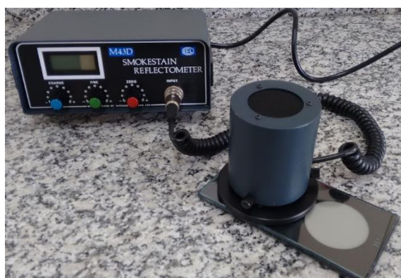
Figura 11: Refletômetro utilizado durante a amostragem.
