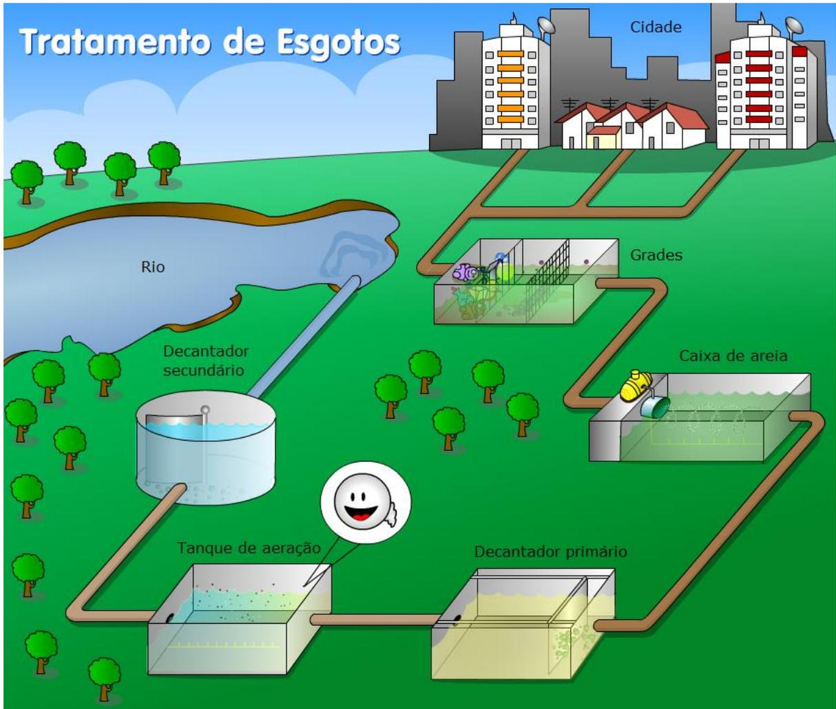
**Figura 1: Modelo Esquemático de Sistema de Tratamento de Águas Residuárias**
