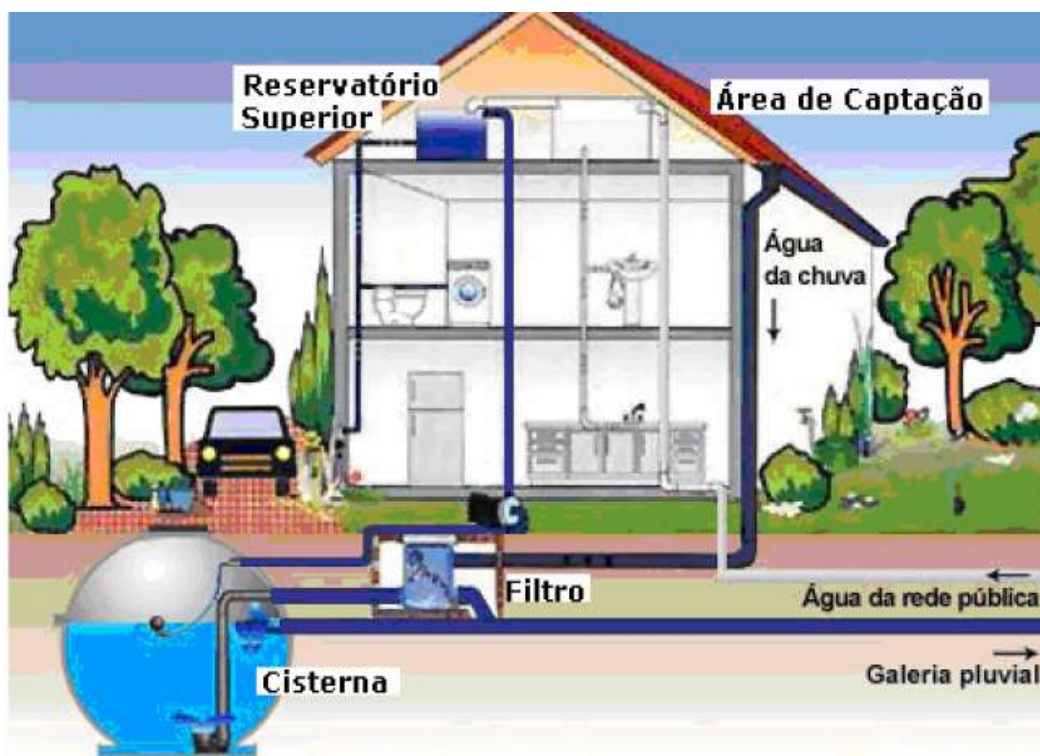
Figura 5 Esquema do sistema de captação de água de chuva. Fonte: CREA Construir (2018).
