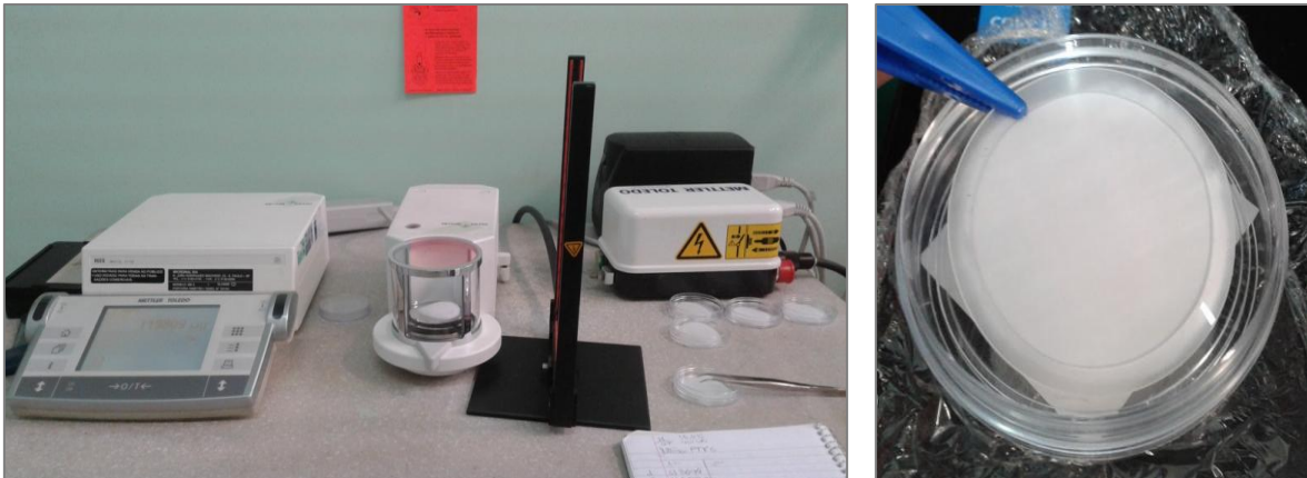
Figura 8 - Balança eletrônica microanalítica modelo MX5 (Mettler Toledo), neutralizador de carga estática Haug (Mettler Toledo) e filtros de PTFE (PALL Corporation) com 37 mm.
