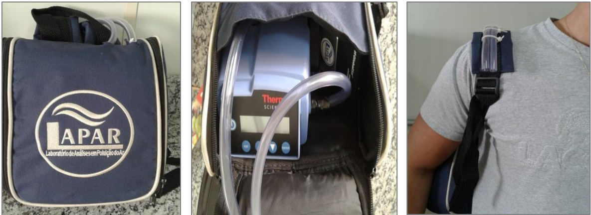
Figura 4 - Mochila contendo o GPS e monitor pessoal com o inlet externo, fixado na alça.
