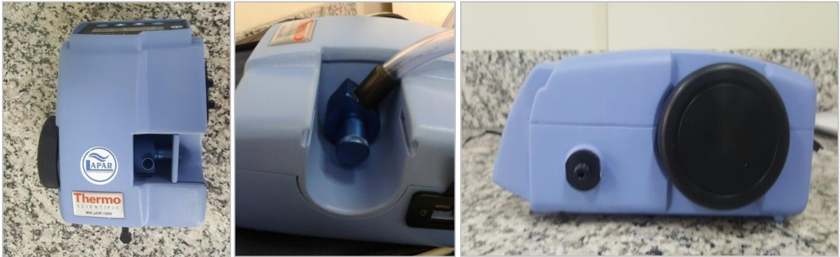
Figura 7 - Equipamento pessoal MIE pDR-1500 (Thermo Fisher Scientific), com ciclone azul referente às partículas até 2,5 \mu\text{m} selecionado.
