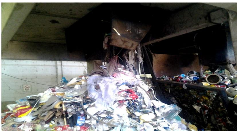
Figura 8: Fotografia do Despejo final da esteira com os rejeitos
