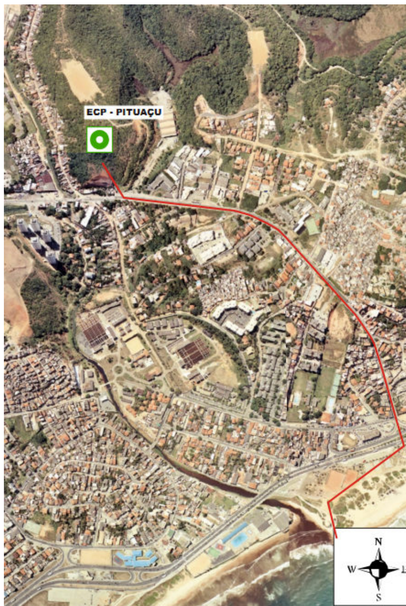
Figura 9. Sistema de Disposição Oceânica do Jaguaribe. Fonte: Geohidro (2005).
