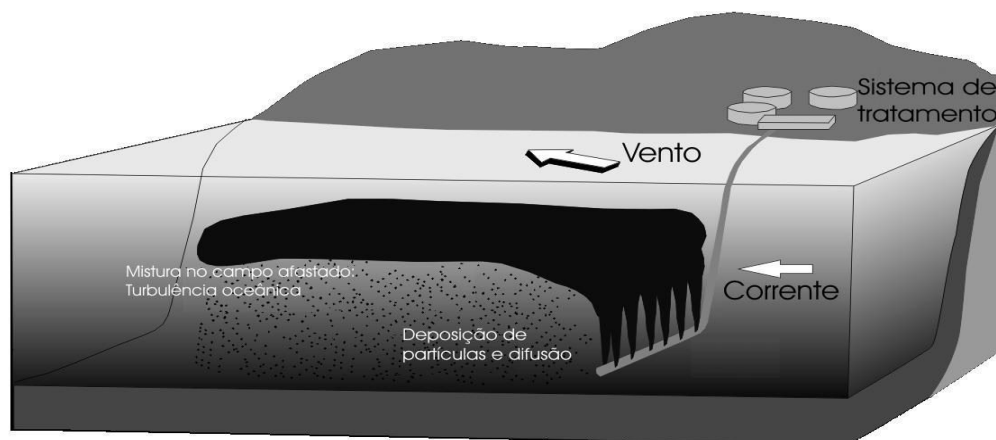
Figura 7 – Comportamento dos Efluentes de um Emissário Submarino. Fonte: Pereira (2010).
