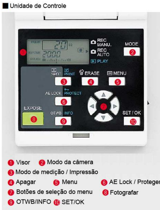
Figura 17 – Unidade de controle da Câmera Olympus DP-12.
