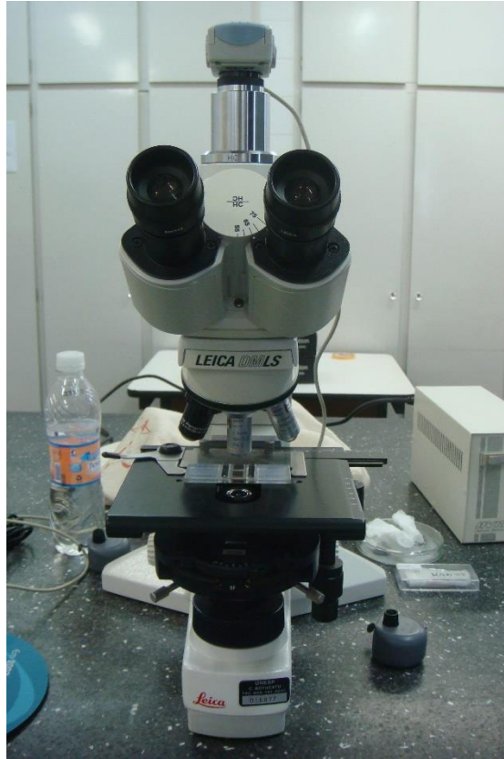
Figura 9 – Microscópio Leica DMLS com câmera fotográfica Motic.
