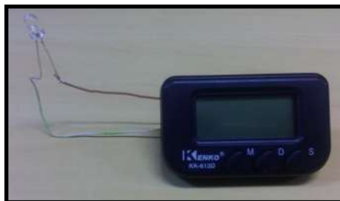
Figura 8: Led conectado ao relógio Fonte: Arquivos do autor
