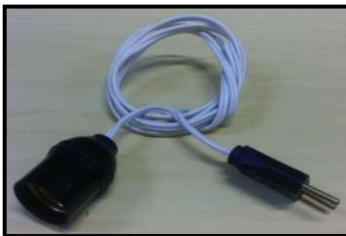
Figura 6: Fio duplo conectado ao pino macho e ao soquete Fonte: Arquivos do autor
