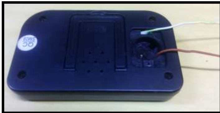
Figura 7: Fios conectados no lugar da pilha Fonte: Arquivos do autor
