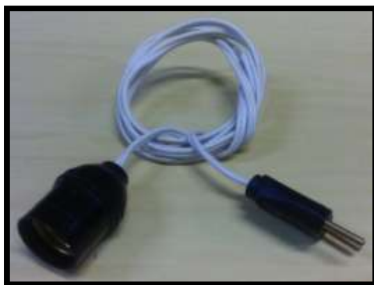
Figura 6: Fio duplo conectado ao pino macho e ao soquete Fonte: Arquivos do autor
