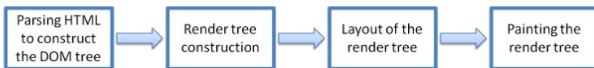
Figura 1 - Fluxo básico do mecanismo de renderização Fonte: Irish e Garsiel (2011).
