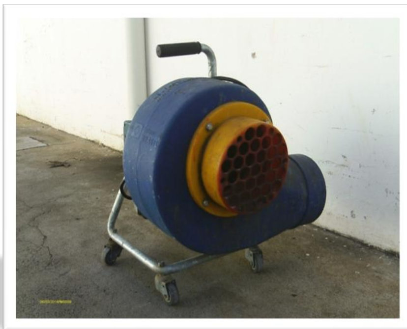
Figura 3 – Insuflador de ar. Utilizado para retirada de gases do ambiente.
