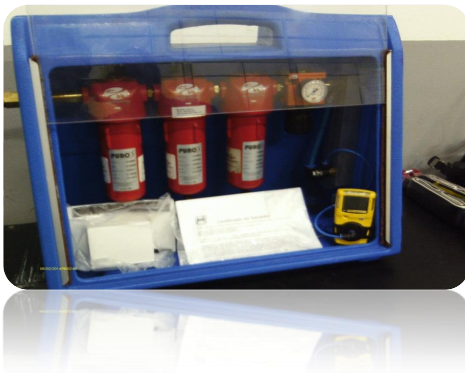
Figura 2 – Estação de ar mandado. Controle de qualidade do ar
