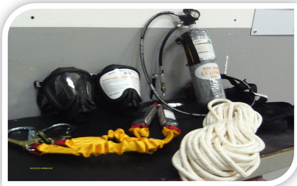
Figura 4-Equipamentos para resgate. Máscaras para equipamento autônomo de oxigênio. Cilindro de escape = 200 BAR 3,1 litros, corda de nylon, cinto e talabarte.
