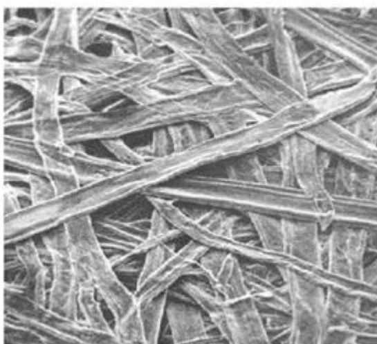
Figura 25 - Folha de papel com fibras não refinadas Fonte: Papermaking Science and Technology (TAPPI 2000)
