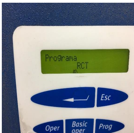
Figura 5 - Prensa programada para teste RCT Fonte: Autor (2017)
