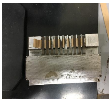
Figura 13 - Preparo da amostra para CMT Fonte: Autor (2017)
