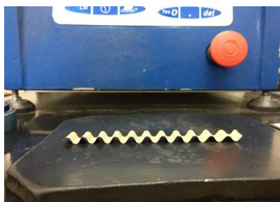
Figura 12 - Amostra para Teste CMT ondulada Fonte: Autor (2017)
