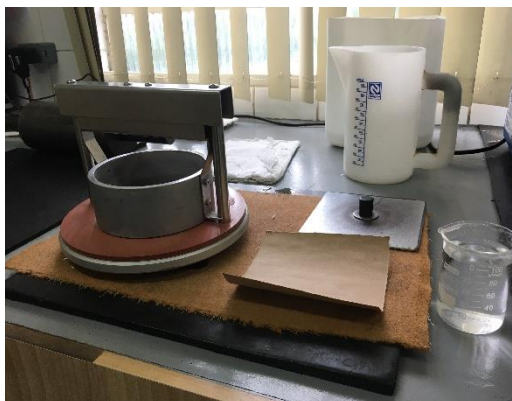
Figura 20 - Amostra e Dispositivo para análise de Cobb Test Fonte: Autor (2017)
