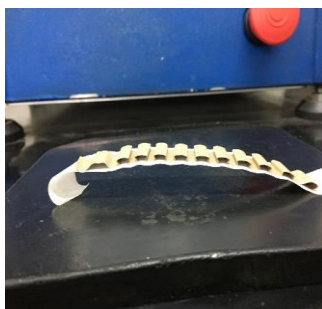
Figura 17 - Amostra colapsada após teste CMT Fonte: Autor (2017)
