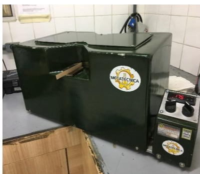
Figura 10 - Concora - Ondulador de amostra para teste CMT Fonte: Autor (2017)
