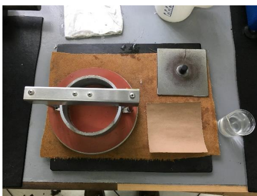
Figura 19 - Amostra e Dispositivo para análise de Cobb Test Fonte: Autor (2017)
