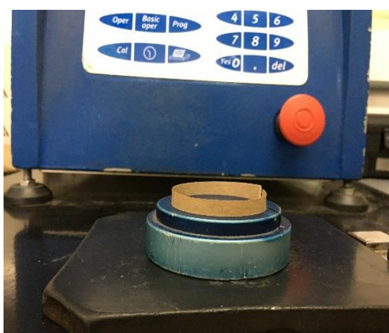
Figura 4 - Suporte para ensaio Teste RCT Fonte: Autor (2017)
