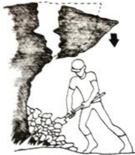
Figura 08: Escavação por baixo, formando desaprumo desfavorável.
