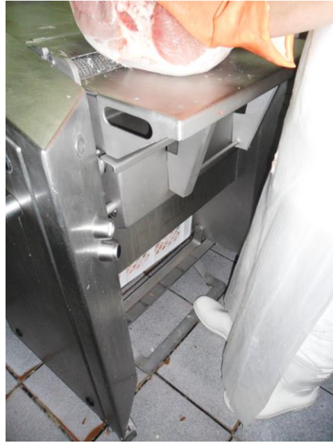
Figura 5 – Equipamento descoradeira com acionamento no pedal. Fonte: A autora (2013)
