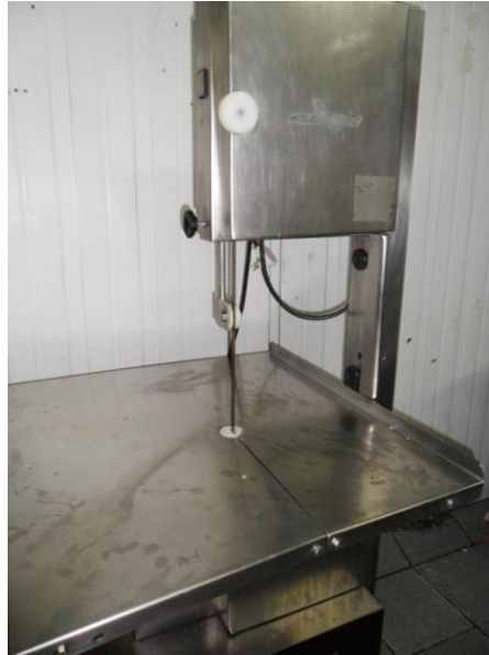
Figura 18 - Máquina serra fita utilizada para cortes de ossos. Fonte: A autora (2013)
