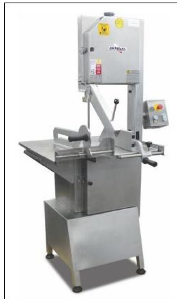
Figura 19 - Máquina serra fita em conforme com a NR 12. Fonte: Sotomano (2013)
