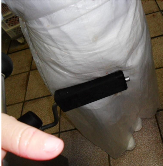
Figura 7 - Equipamento embutideira semiautomática com comando acionado na perna. Fonte: A autora (2013)
