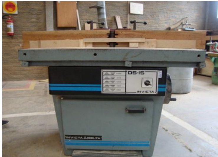
Figura 13 - Tupia com chave (partida e parada) inadequada. Fonte: O autor, 2013.
