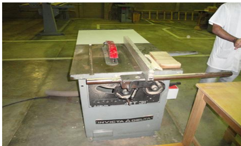
Figura 9 - Ausência da coifa protetora c/ alavanca de regulação na serra circular. Fonte: O autor 2013.
