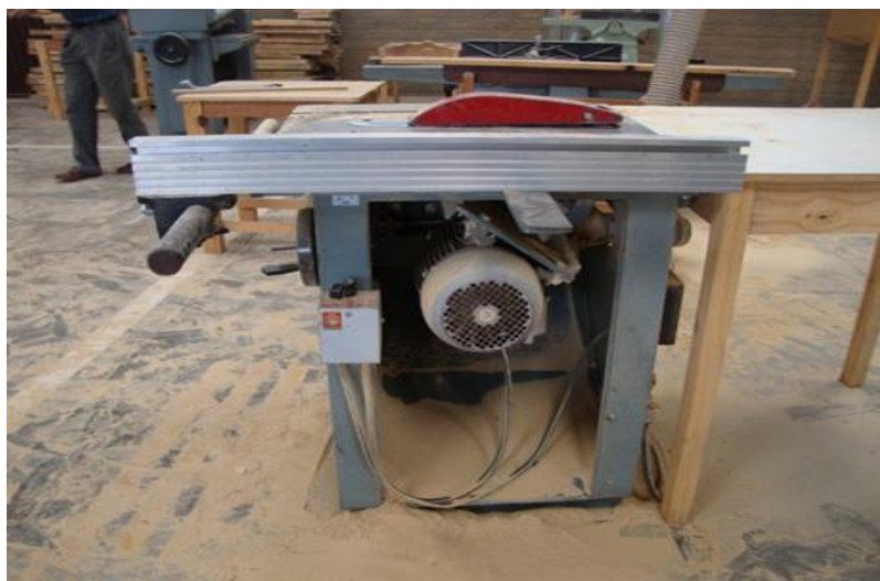
Figura 8 - Serra circular sem exaustor, no ambiente da prática educacional. Fonte: O autor, 2013.
