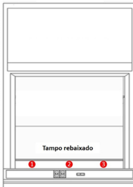
Figura 1 – Representação esquemática dos pontos de aferição das velocidades de face (Fonte: imagem adaptada de BRASILAB)
