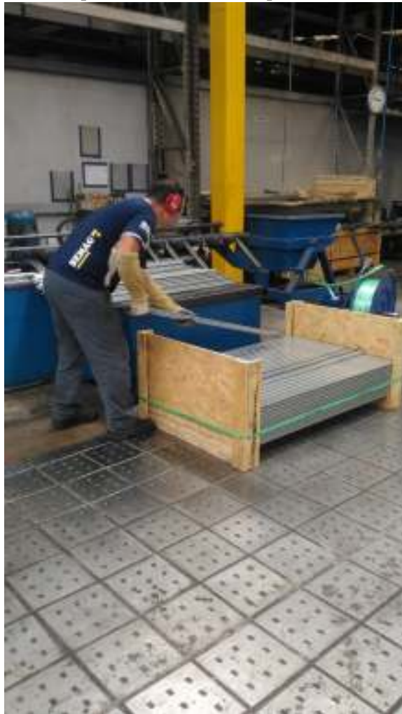
FIGURA 5 – Operador embalando as peças na altura do chão
