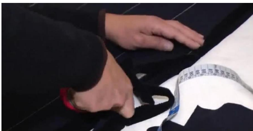
Figura 5: Ilustração de riscos no tecido e o corte sendo realizado com tesoura
