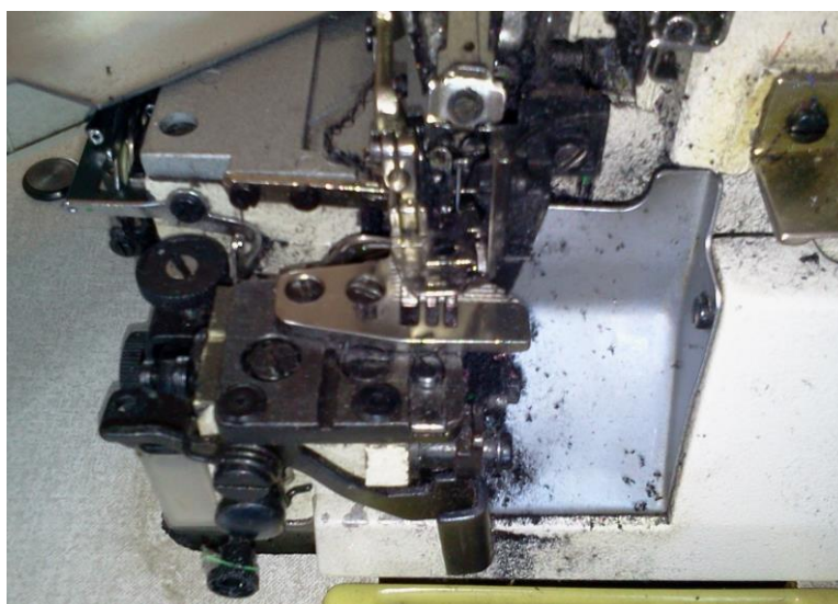
Figura 11: Máquina de overlocke coberta com pó (resíduo dos tecidos) Fonte: Acervo próprio
